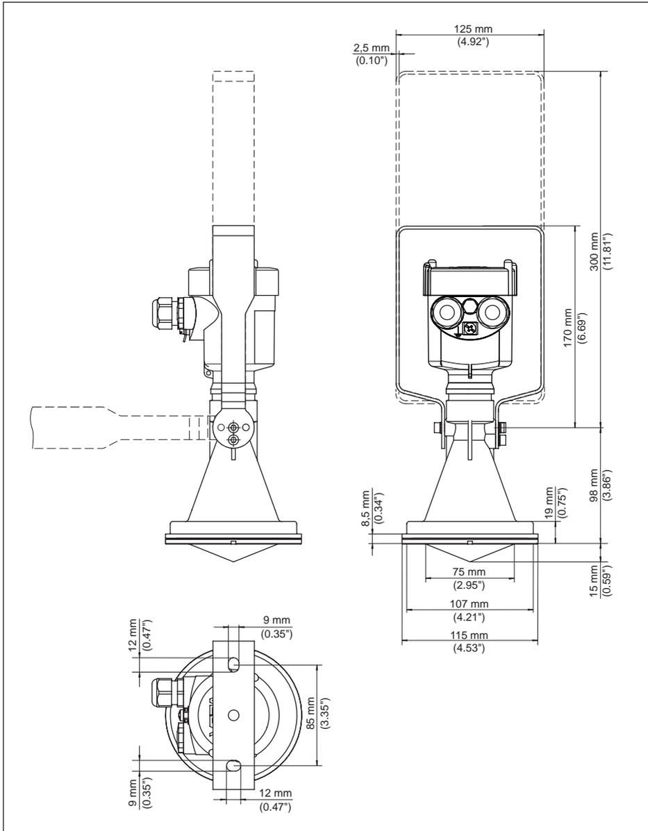
Abb. 59: VEGAPULS 67, Montagebügel in 170 oder 300 mm Länge
