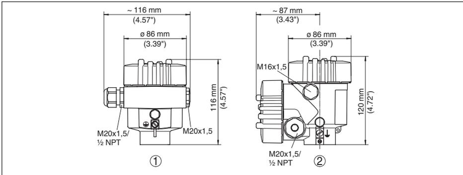
Abb. 55: Gehäuseausführungen in Schutzart IP 66/IP 68 (0,2 bar), (mit eingebautem Anzeige- und Bedienmodul vergrößert sich die Gehäusehöhe um 18 mm/0.71 in)
