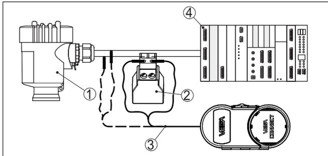
Abb. 40: Anschluss des PCs via HART an die Signalleitung
