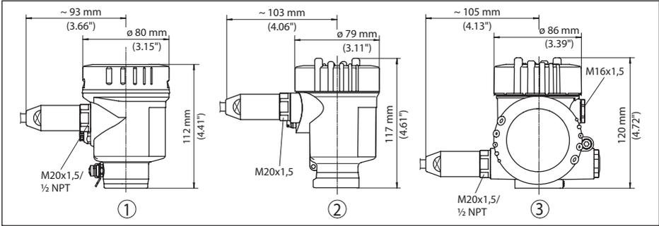
Abb. 58: Gehäuseausführungen in Schutzart IP 66/IP 68 (1 bar), (mit eingebautem Anzeige- und Bedienmodul vergrößert sich die Gehäusehöhe um 18 mm/0.71 in)
