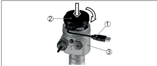
Abb. 39: Anschluss des PCs via Schnittstellenadapter direkt am Sensor
