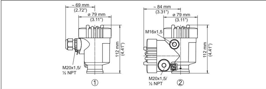
Abb. 54: Gehäuseausführungen in Schutzart IP 66/IP 67 (mit eingebautem Anzeige- und Bedienmodul vergrößert sich die Gehäusehöhe um 9 mm/0.35 in)
