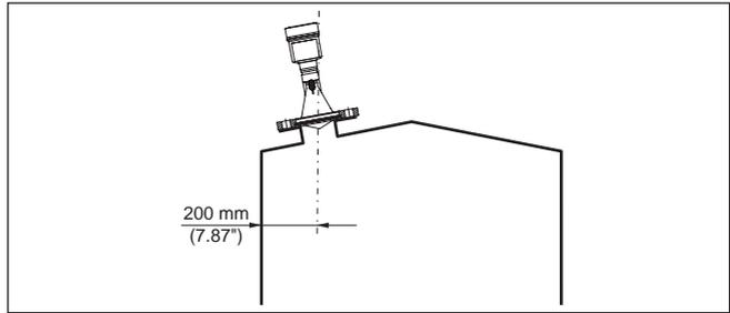
Abb. 7: Montage des Radarsensors an der Behälterdecke
