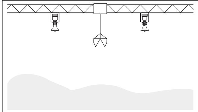
Abb. 16: Radarsensoren an einer Krantraverse
