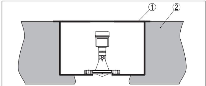
Abb. 19: Montage des Gerätes in einem Unterflurkasten
