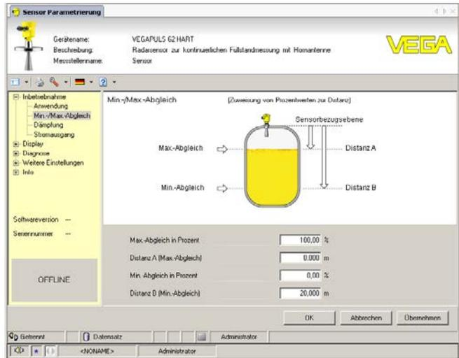
Abb. 41: Beispiel einer DTM-Ansicht
