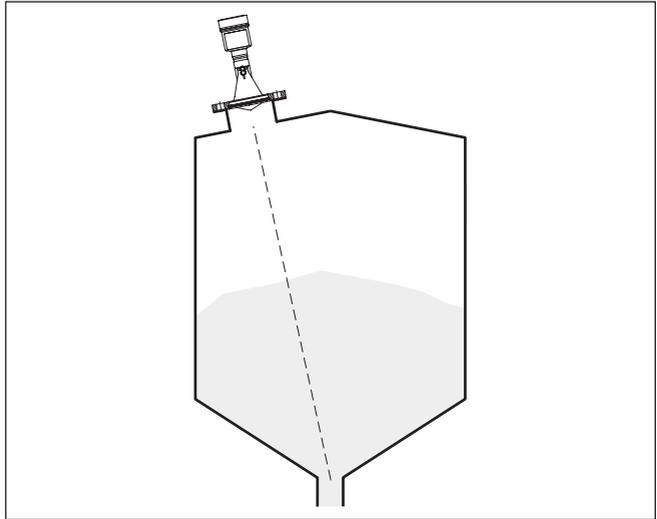
Abb. 12: Ausrichtung in Silos
