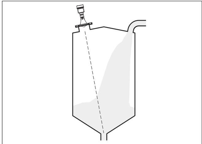
Abb. 8: Montage des Radarsensors bei einströmendem Medium mit Befüllung von oben
