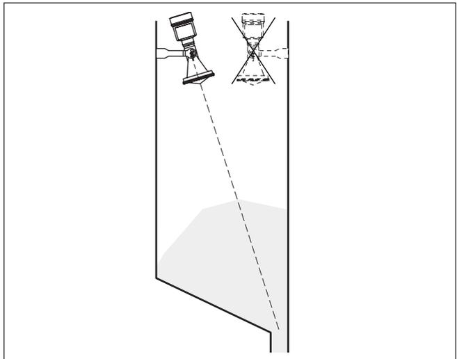
Abb. 21: Einbau und Ausrichtung in Mehrkammersilos
