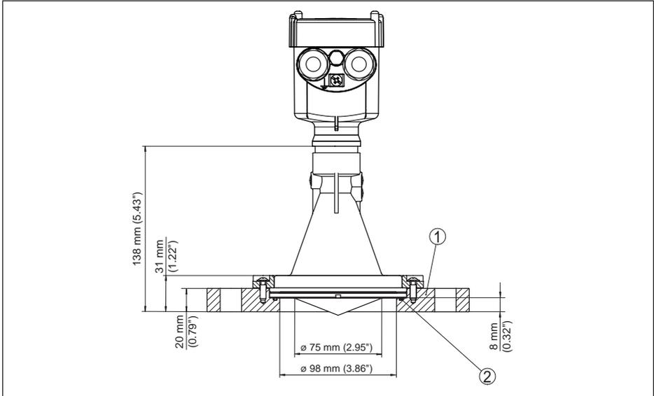
Abb. 62: VEGAPULS 67, Adapterflansch
