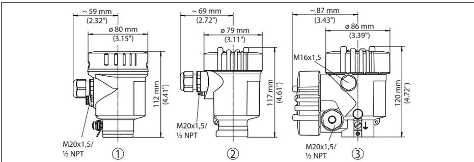
Abb. 57: Gehäuseausführungen in Schutzart IP 66/IP 68 (0,2 bar), (mit eingebautem Anzeige- und Bedienmodul vergrößert sich die Gehäusehöhe um 18 mm/0.71 in)
