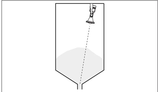
Abb. 14: Montage an Behälterdecke
