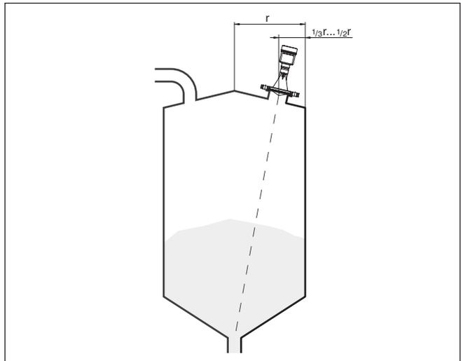
Abb. 15: Montageposition und Ausrichtung
