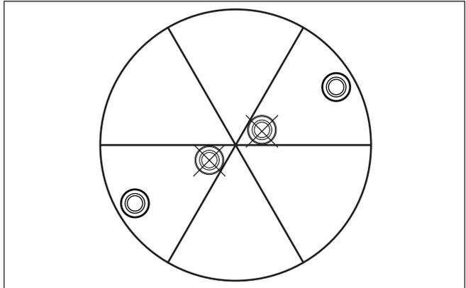
Abb. 20: Einbau und Ausrichtung in Mehrkammersilos
