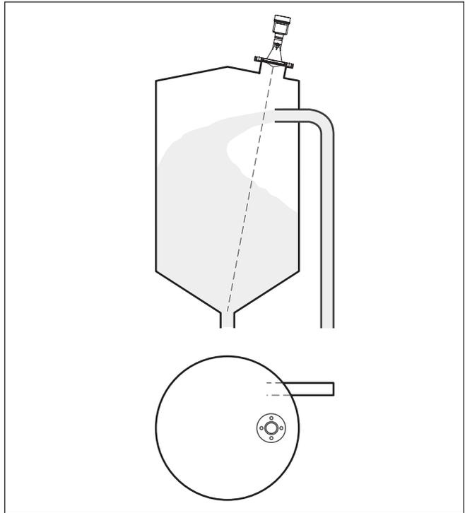
Abb. 9: Montage des Radarsensors bei einströmendem Medium mit seitlicher Befüllung
