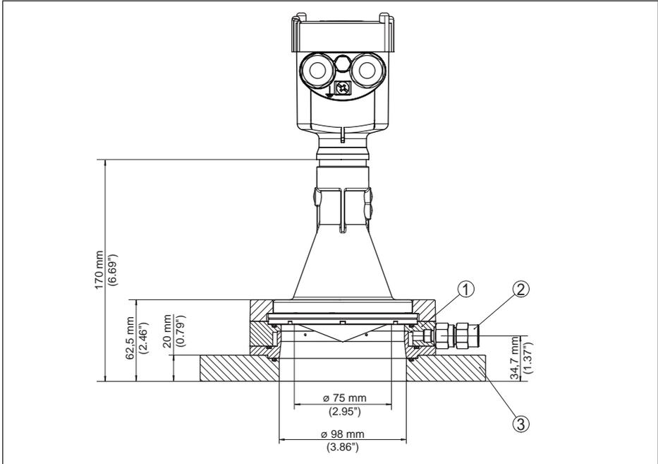
Abb. 63: VEGAPULS 67, Adapterflansch mit Luftspülung
