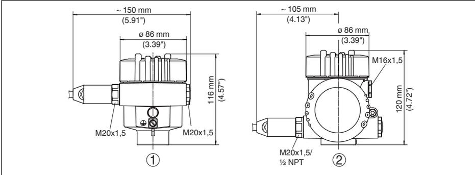
Abb. 56: Gehäuseausführungen in Schutzart IP 66/IP 68 (1 bar), (mit eingebautem Anzeige- und Bedienmodul vergrößert sich die Gehäusehöhe um 18 mm/0.71 in)
