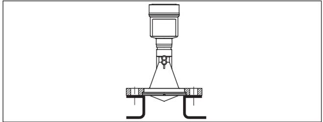
Abb. 10: Empfehlenswerte Rohrstützenmontage
