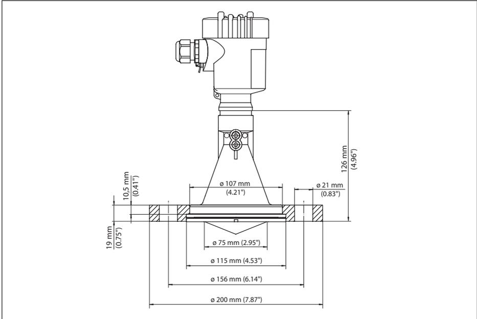
Abb. 60: VEGAPULS 67, Überwurfflansch passend für DN 80 PN 16, ASME 3" 150lbs, JIS80 10K
