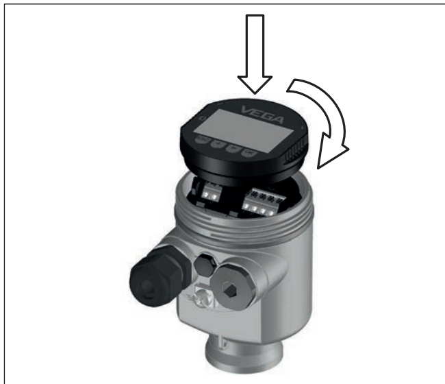
Fig. 34: Plaatsen van de display- en bedieningsmodule bij eenkamerbehuizing in elektronicaruiimte.
