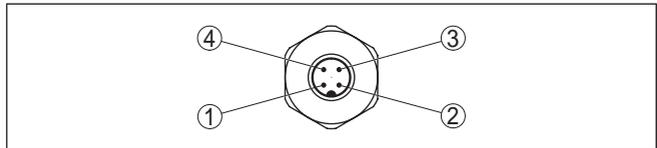
Abb. 35: Sicht auf den Steckverbinder M12 x 1
