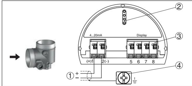
Abb. 29: Anschlussraum - Zweikammergehäuse
