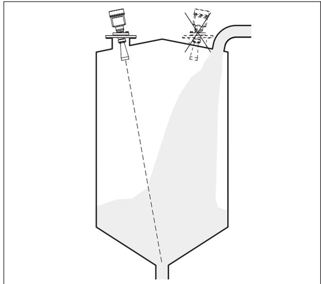
Abb. 7: Montage des Radarsensors bei einströmendem Medium
