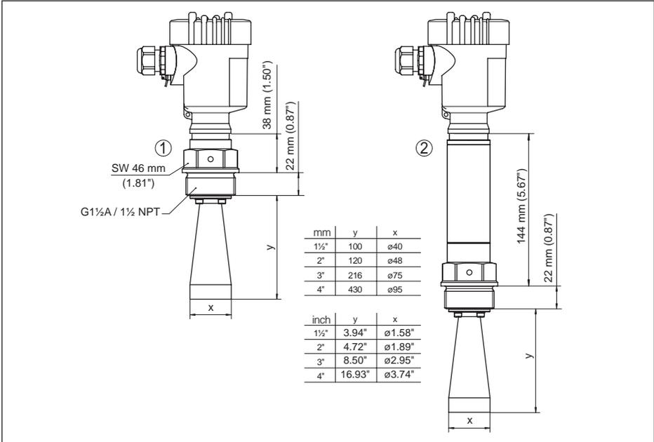
Abb. 62: VEGAPULS 68, Hornantenne in Gewindeausführung
