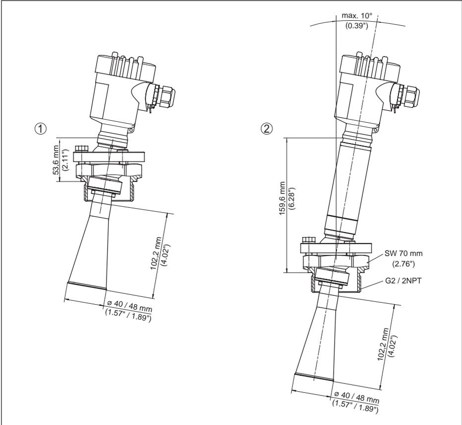
Abb. 67: VEGAPULS 68, Hornantenne und Schwenkhalterung, Gewindeanschluss
