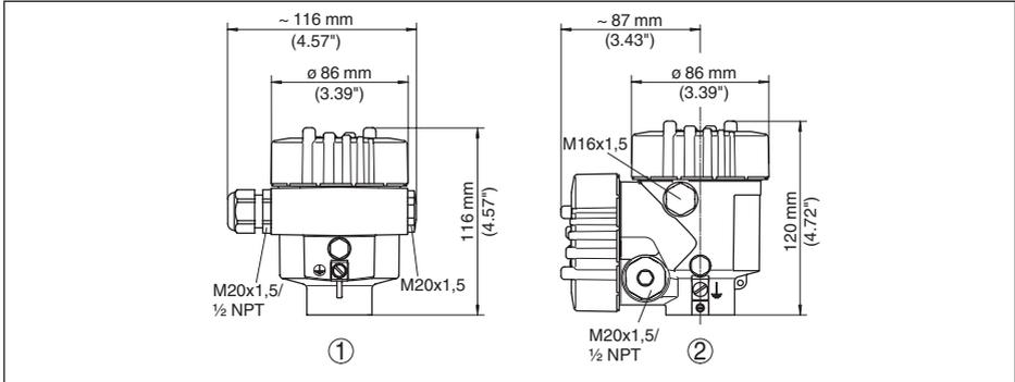
Abb. 58: Gehäuseausführungen in Schutzart IP 66/IP 68 (0,2 bar), (mit eingebautem Anzeige- und Bedienmodul vergrößert sich die Gehäusehöhe um 18 mm/0.71 in)
