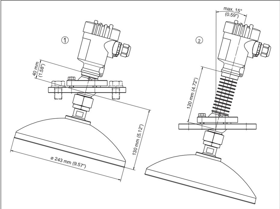
Abb. 68: VEGAPULS 68, Parabolantenne und Schwenkhalterung
