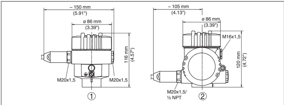
Abb. 59: Gehäuseausführungen in Schutzart IP 66/IP 68 (1 bar), (mit eingebautem Anzeige- und Bedienmodul vergrößert sich die Gehäusehöhe um 18 mm/0.71 in)
