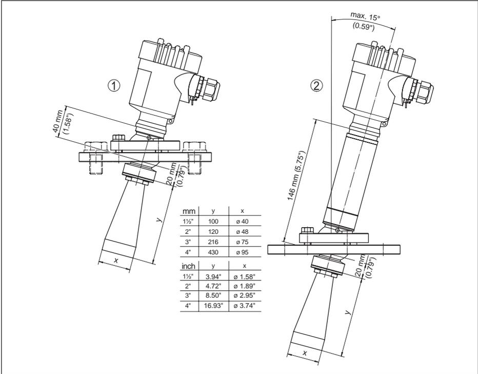
Abb. 66: VEGAPULS 68, Hornantenne und Schwenkhalterung
