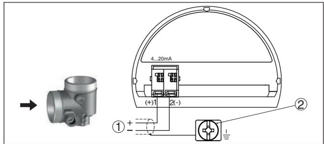
Abb. 32: Anschlussraum - Ex-d-ia-Zweikammergehäuse
