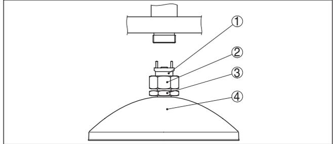
Abb. 4: Demontage Parabolantenne
