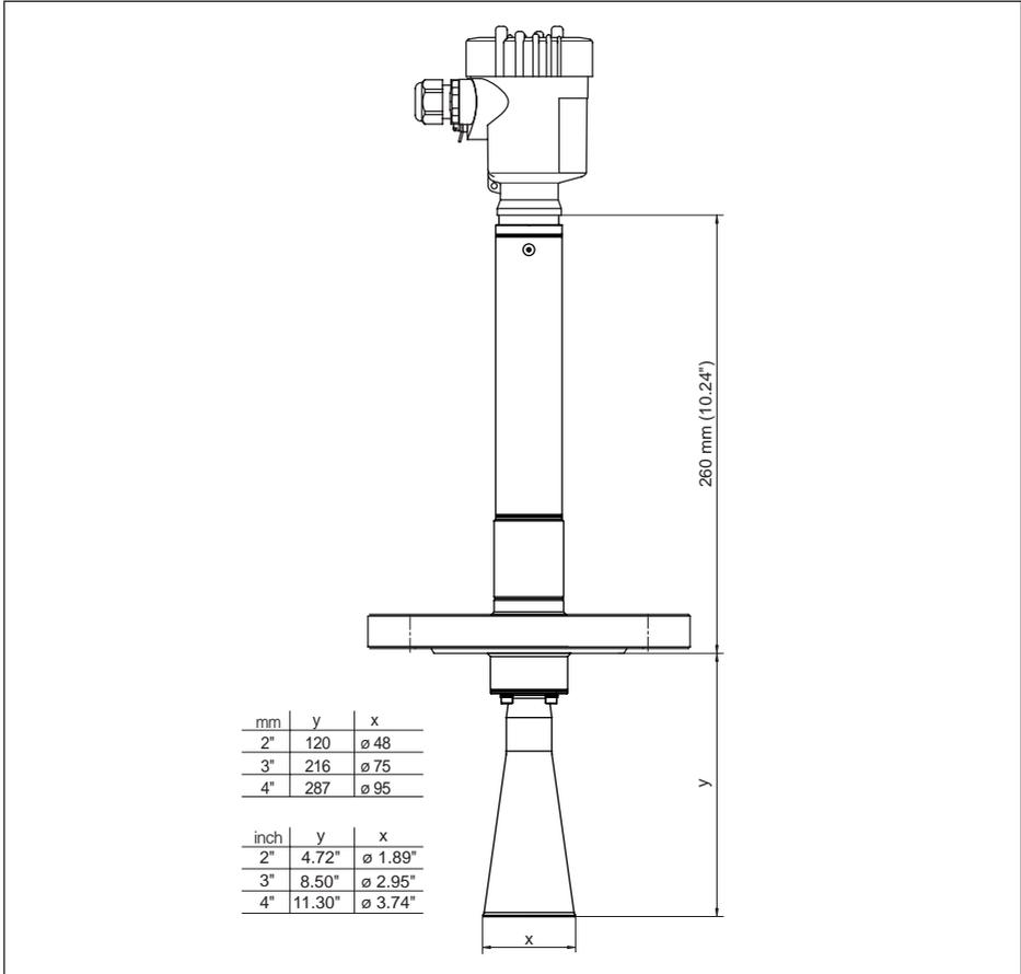
Abb. 65: VEGAPULS 68, Hornantenne in Flanschausführung mit Temperaturzwischenstück bis 450 °C
