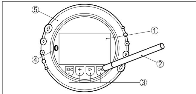
Abb. 40: Anzeige- und Bedienelemente - mit Bedienung über Magnetstift
