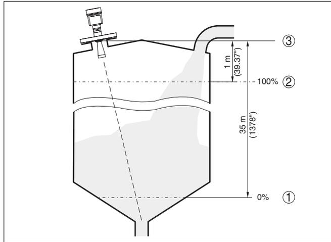
Abb. 41: Parametrierbeispiel Min.-/Max.-Abgleich
