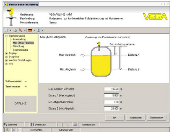
Abb. 44: Beispiel einer DTM-Ansicht
