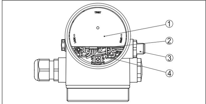
Abb. 34: Sicht auf den Elektronikraum mit VEGADIS-Adapter zum Anschluss der externen Anzeige- und Bedieneinheit
