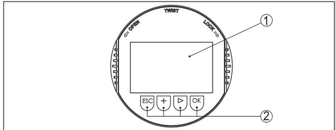
Abb. 39: Anzeige- und Bedienelemente
