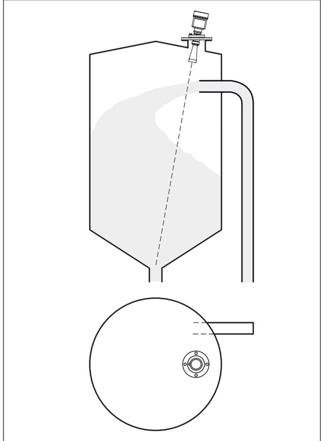
Abb. 8: Montage des Radarsensors bei einströmendem Medium
