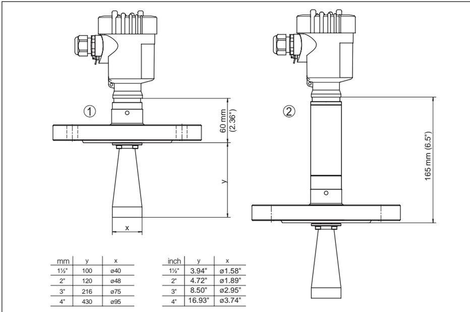
Abb. 63: VEGAPULS 68, Hornantenne in Flanschausführung
