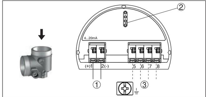
Abb. 31: Elektronikraum - Ex-d-ia-Zweikammergehäuse
