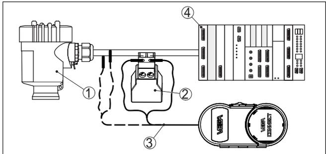
Abb. 43: Anschluss des PCs via HART an die Signalleitung
