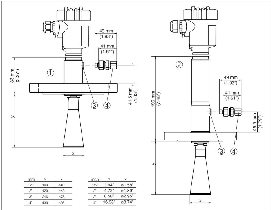
Abb. 64: VEGAPULS 68, Hornantenne in Flanschführung mit Spülluftanschluss
