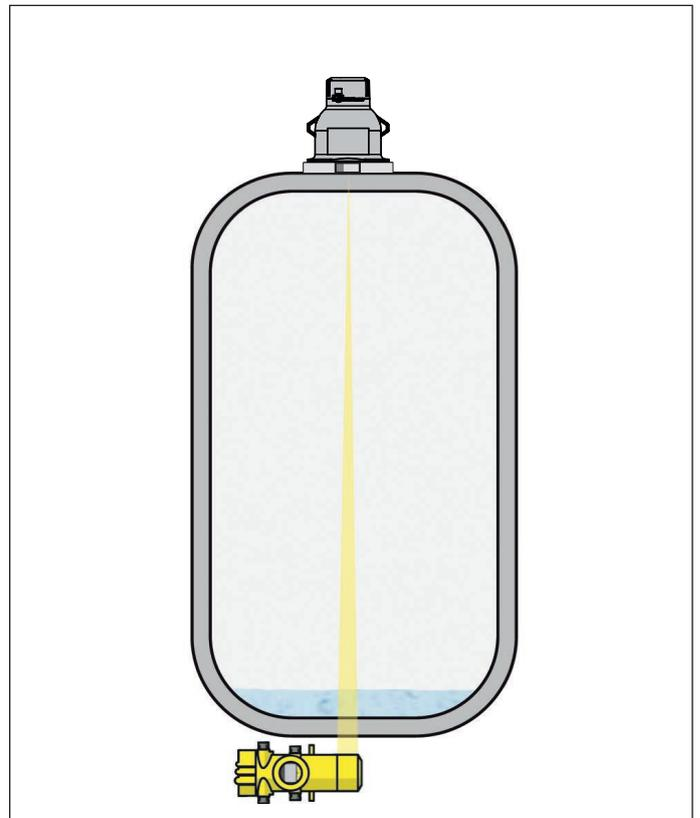
Fig. 16: MINITRAC monté par le bas
