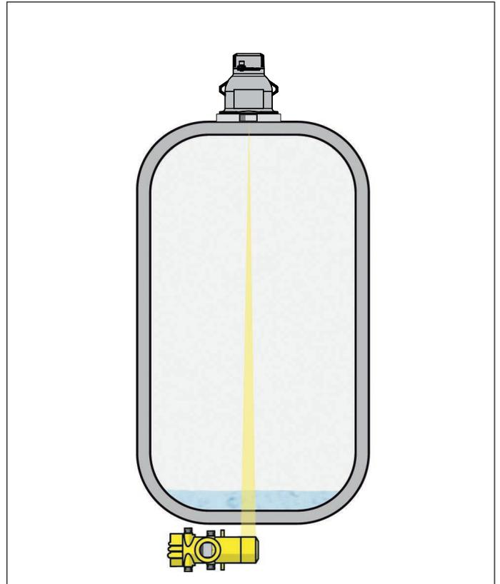
Figura 6: Misura di livello per livelli bassi
