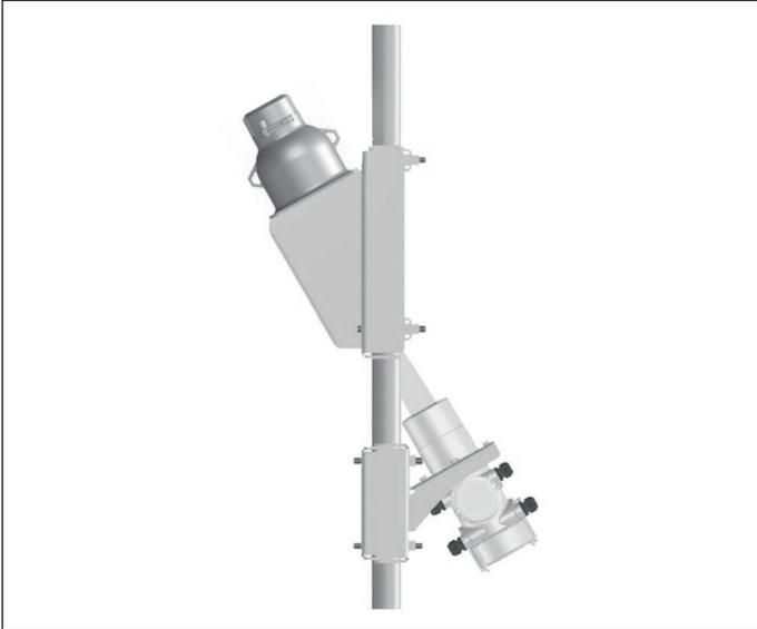
插图 5: 测量仪表在直径为 50 ... 100 mm 的管道上的安装位置
