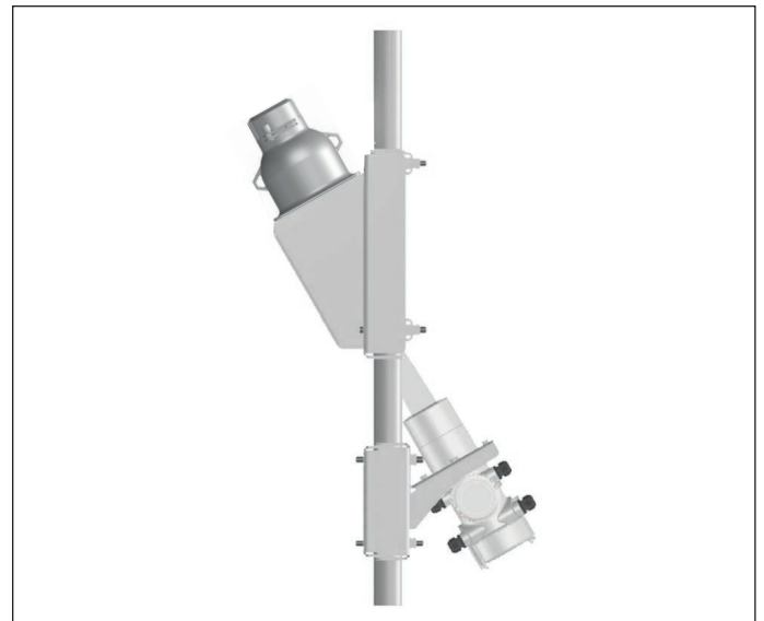
Fig. 38: Dispositivo de fixação para montagem inclinada em tubos de 50 ... 100 mm (1.97 ... 3.94 in)
