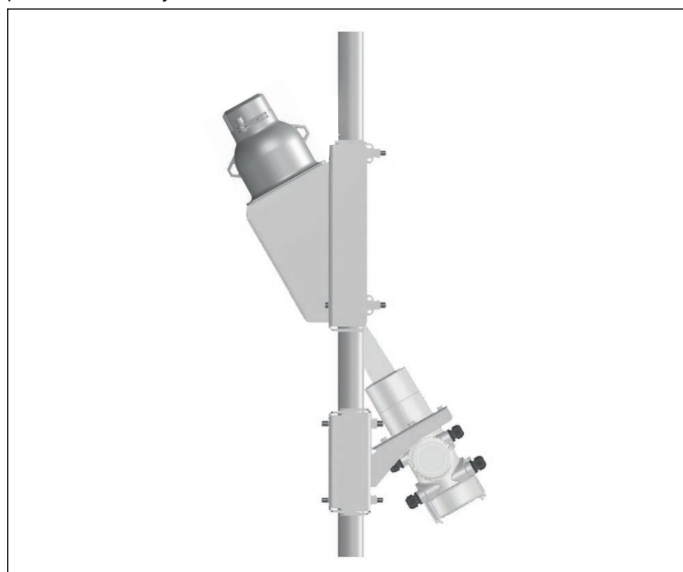
Rys. 5: Rozmieszczenie układu pomiarowego na rurociągu o średnicy w zakresie 50 ... 100 mm
