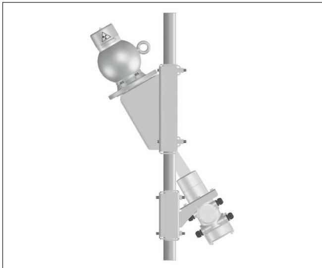
Fig. 18: 30°-meetopstelling op een leiding met diameter 50 ... 100 mm (1.97 ... 3.94 in)
