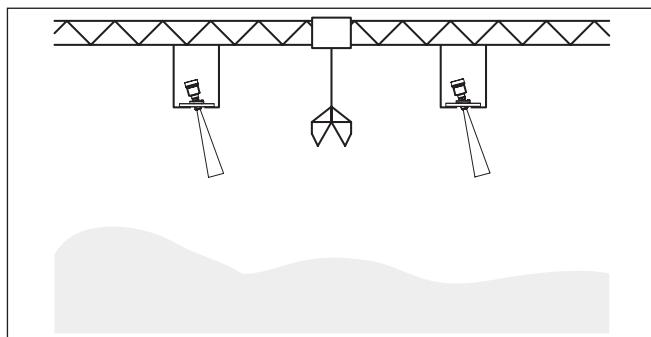
插图. 18: 在一个起重机横梁上的雷达传感器
