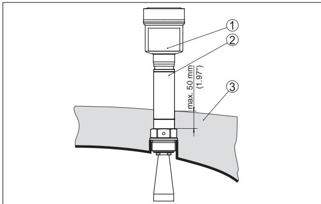
插图. 19: 将仪表安装在绝缘容器上。
