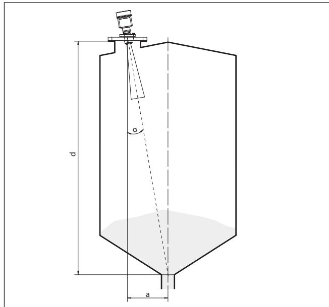
插图. 14: 校准 VEGAPULS SR 68 后的安装建议
