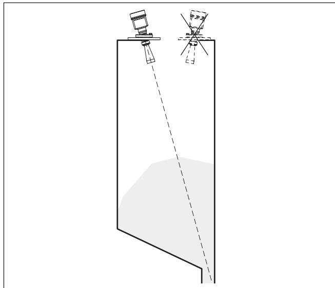
插图. 22: 将 VEGAPULS SR 68 朝向料仓中央的排空位置
