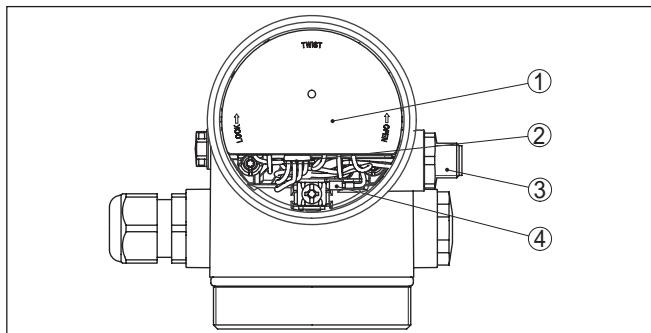
插图. 33: 目检带有与外部显示和调整单元相连接的 VEGADIS-Adapter 的电子部件腔
