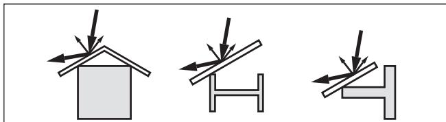
插图. 16: 用散射挡板来覆盖光滑的型材
