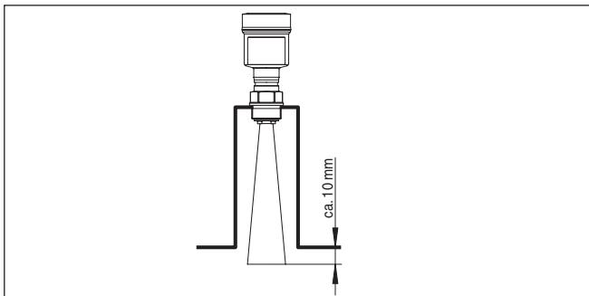
插图. 8: 号角天线上推荐的管接头安装方式
