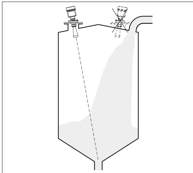
插图. 6: 流入介质时安装雷达传感器
