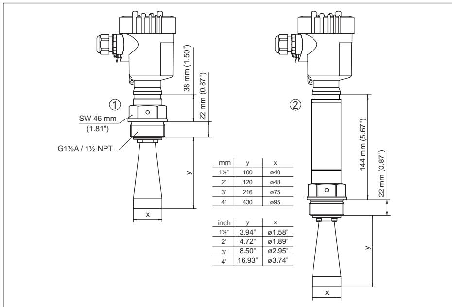
插图. 61: VEGAPULS SR 68, 号角天线, 螺纹型
