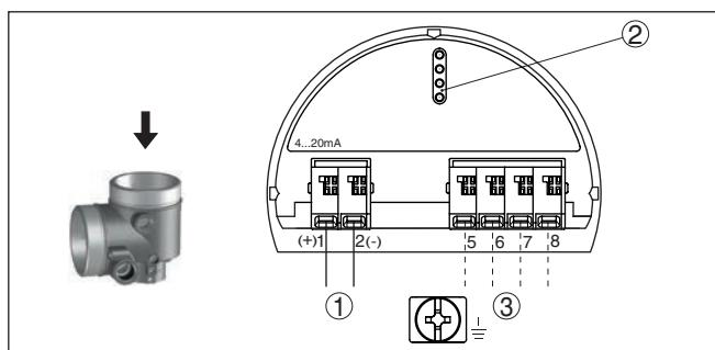
插图. 30: 防爆 (Ex-d-ia) 型双腔式壳体的电子部件腔
