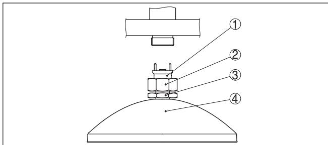
插图. 3: 抛物形天线的拆卸
