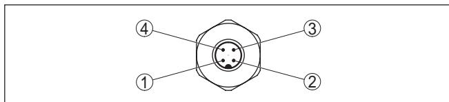
插图. 34: 目检连接插头 M12 x 1
