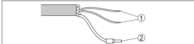
插图. 35: 固定连接的连接电缆的芯线分布
