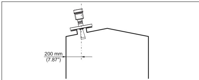
插图. 5: 将雷达传感器安装在容器盖上
