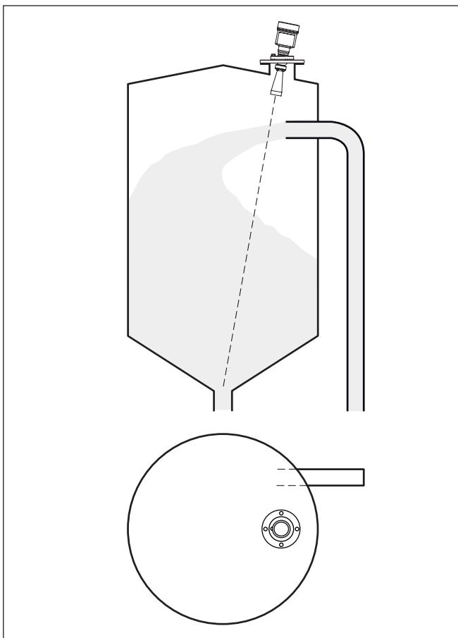
插图. 7: 流入介质时安装雷达传感器
