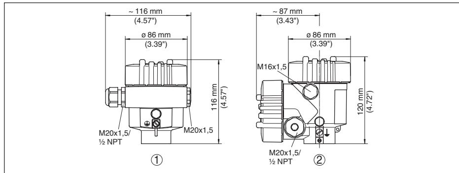
插图. 57: 采用保护等级达 IP 66/IP 68 (0.2 bar) 的壳体型式 (内装显示和调整模块后，壳体高度增加了18 mm/0.71 in)
