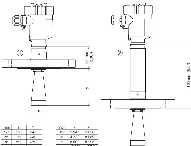
插图. 62: VEGAPULS SR 68 , 号角天线 , 法兰型
