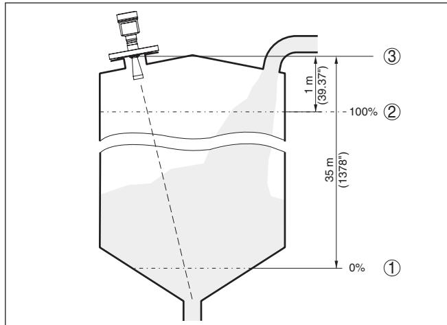
插图. 40: 有关最小/最大调整的参数化举例
