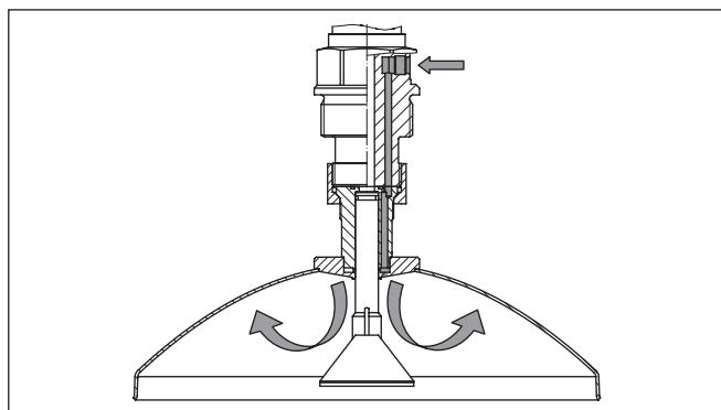
插图. 24: 针对抛物形天线的冲洗空气接头
