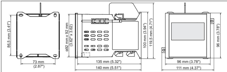
Fig. 11: Dimensions VEGAMET 391 mit SIL-Qualifikation
