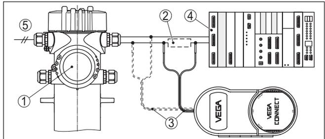
Abb. 19: Anschluss des PCs via HART an die Signalleitung
