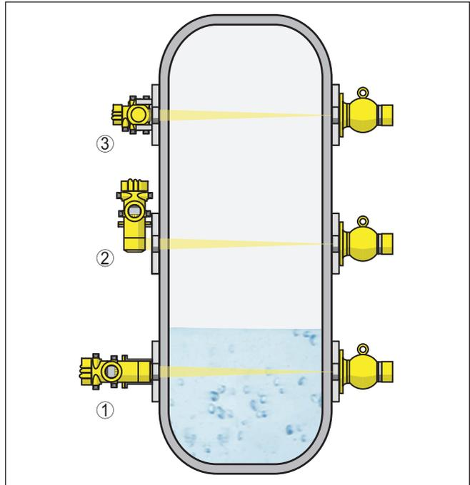
Abb. 5: Montageposition - Grenzstanderfassung - Ausführung ohne Detektorrohr
