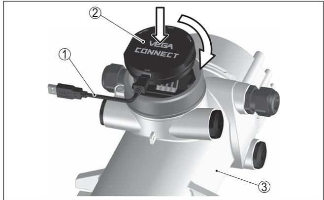
Abb. 18: Anschluss des PCs via Schnittstellenadapter direkt am Sensor
