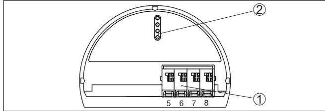
Abb. 12: Bedien- und Anschlussraum bei Nicht-Ex-Geräten und Geräten mit nicht-eigersicherem Stromausgang
