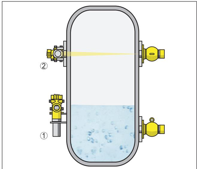
Abb. 4: Montageposition - Grenzstanderfassung - Ausführung mit Detektorrohr
