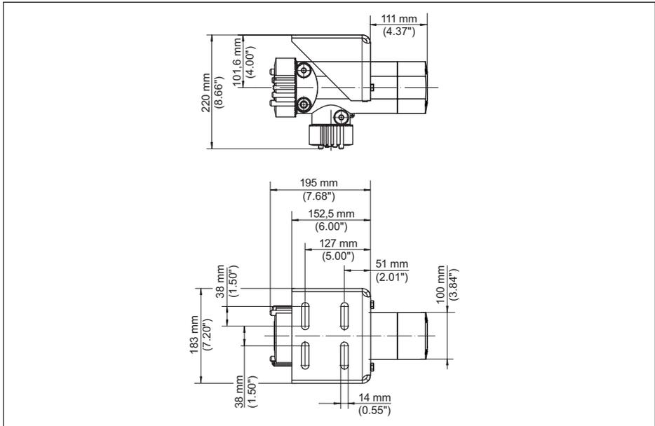
Fig. 28: POINTRAC 31 sans tube détecteur, 46 mm (1.8 in) - avec accessoires de montage fournis
