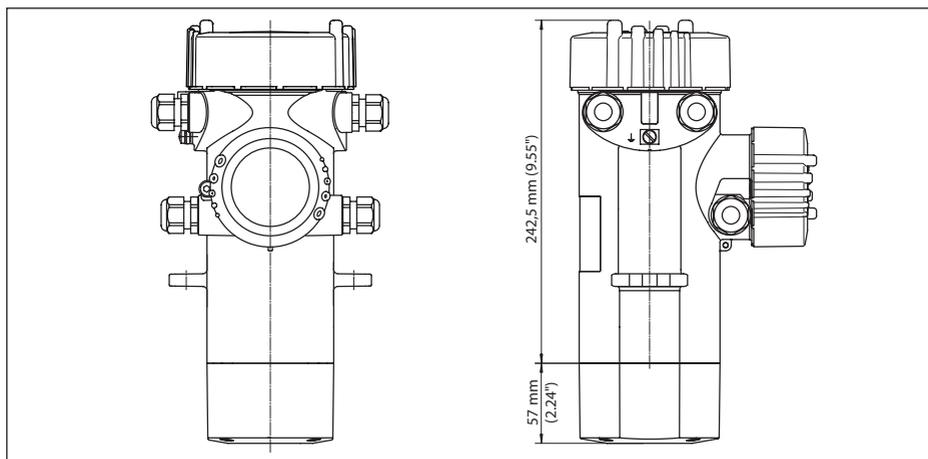
Fig. 27: POINTRAC 31 sans tube détecteur - plage de mesure = longueur de commande 46 mm (1.8 in)
