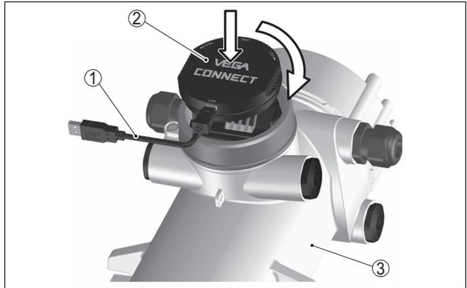
Fig. 19: Raccordement du PC directement au capteur via l'adaptateur d'interfaces
