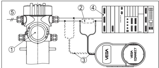
Fig. 20: Raccordement du PC à la ligne signal via HART
