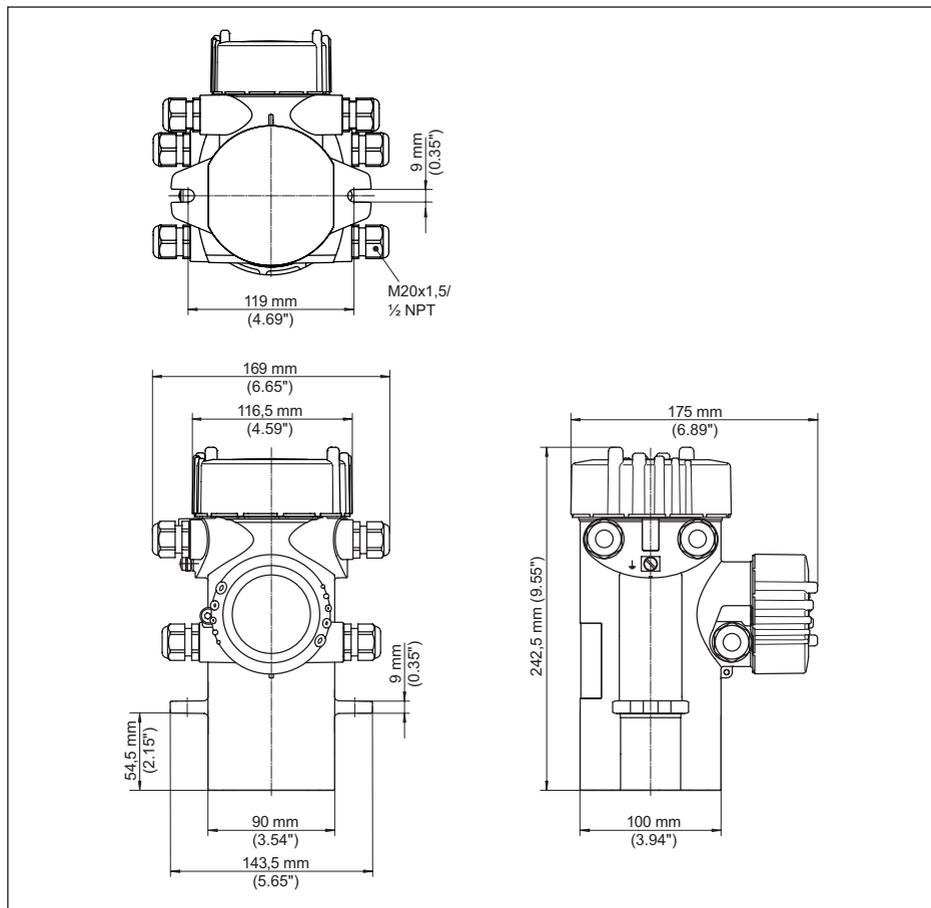
Fig. 24: Boîtier en aluminium ou boîtier en acier inox (moulage cire-perdue)
