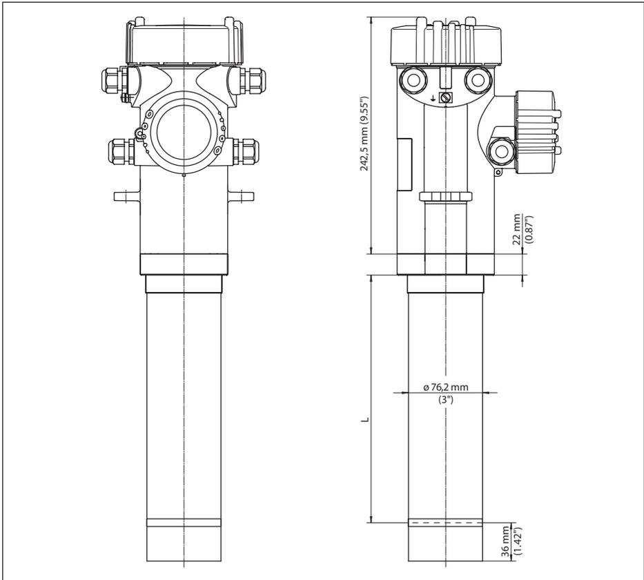
Fig. 25: POINTRAC 31 avec tube détecteur - Longueur de mesure : 152 mm ou 304 mm (6 in/12 in)
