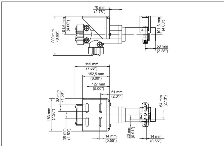
Fig. 26: POINTRAC 31 avec tube détecteur, 152 mm ou 304 mm (6 in/12 in) - avec accessoires de montage fournis
