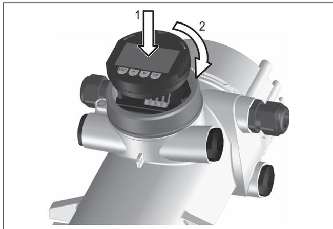
Fig. 16: Insertion du module de réglage et d'affichage
