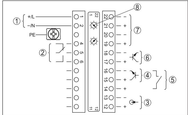
Abb. 12: Elektronik- und Anschlussraum (Ex d) bei Geräten mit eigensicherem Stromausgang
