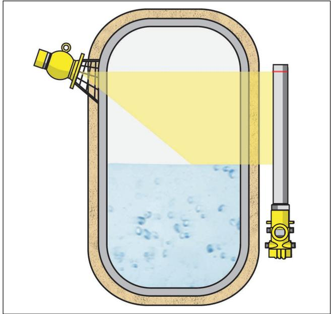
Abb. 8: Füllstandmessung an einem beheizten Behälter mit Wärmeisolierung
