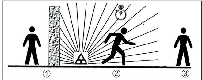
Abb. 4: Maßnahmen zum Schutz vor radioaktiver Strahlung
