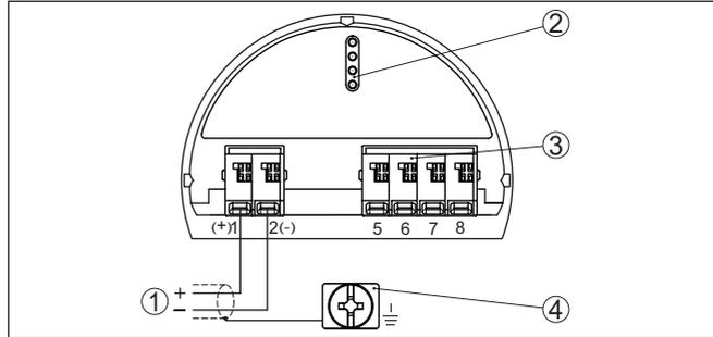
Abb. 17: Bedien- und Anschlussraum (Ex ia) bei Geräten mit eigenem Stromausgang
