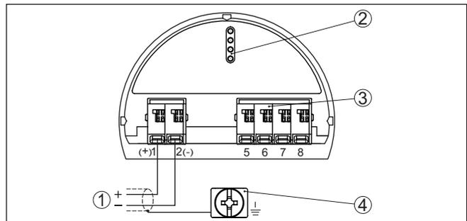
Abb. 13: Bedien- und Anschlussraum (Ex ia) bei Geräten mit eigensicherem Stromausgang
