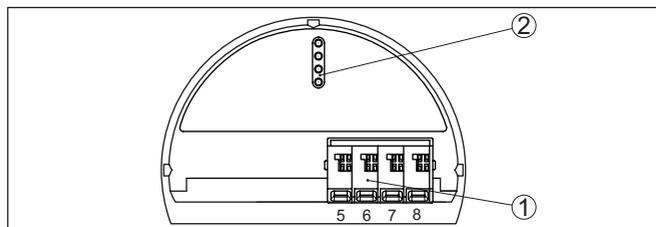
Abb. 15: Bedien- und Anschlussraum bei Nicht-Ex-Geräten und Geräten mit nicht-eigensicherem Stromausgang
