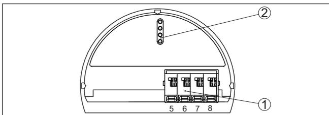
Abb. 11: Bedien- und Anschlussraum bei Nicht-Ex-Geräten und Geräten mit nicht-eigensicherem Stromausgang
