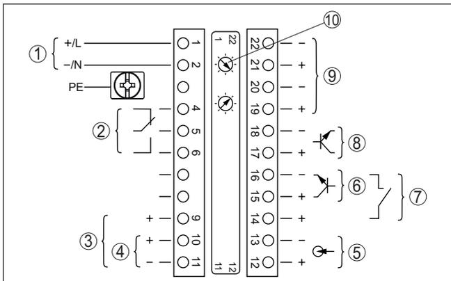
Abb. 10: Elektronik- und Anschlussraum bei Nicht-Ex-Geräten und Geräten mit nicht-eigensicherem Stromausgang
