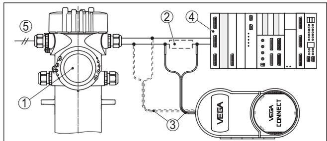
Abb. 23: Anschluss des PCs via HART an die Signalleitung
