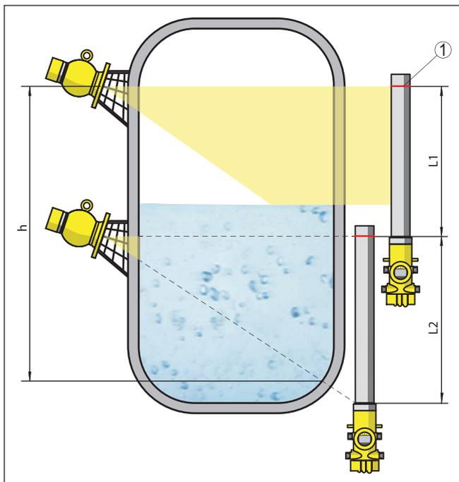
Fig. 7: Position de montage - Agencement en cascade
