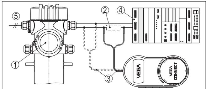
Fig. 23: Raccordement du PC à la ligne signal via HART
