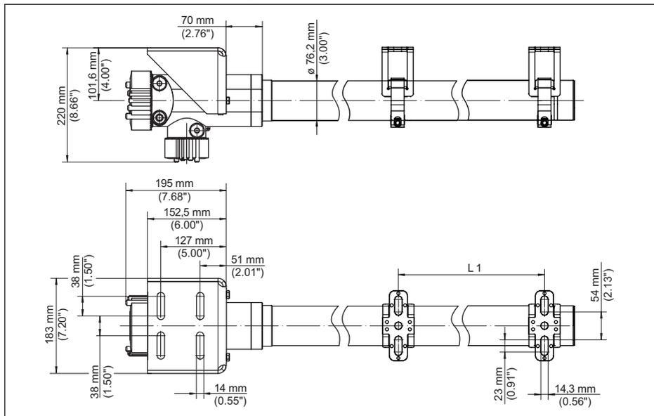
Fig. 29: SOLITRAC 31 avec des accessoires de montage compris à la livraison
