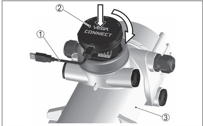
Fig. 22: Raccordement du PC directement au capteur via l'adaptateur d'interfaces
