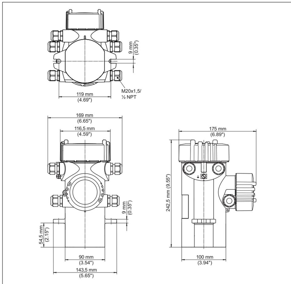
Fig. 27: Boîtier en aluminium ou boîtier en acier inox (moulage cire-perdue)
