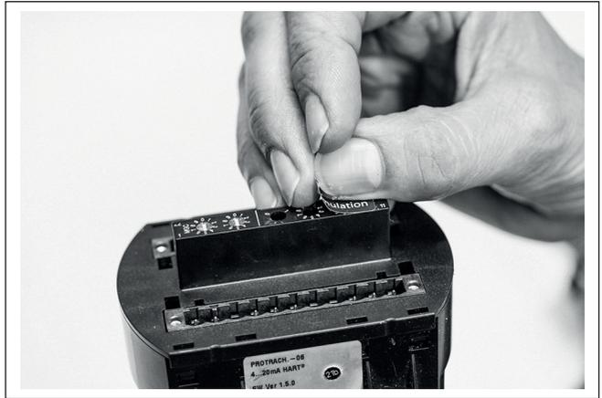
插图. 2: Profibus PA - 揭去地址选择开关上的盖膜
