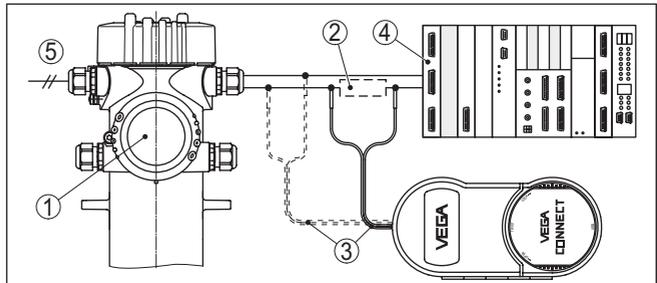
Fig. 25: Raccordement du PC à la ligne signal via HART
