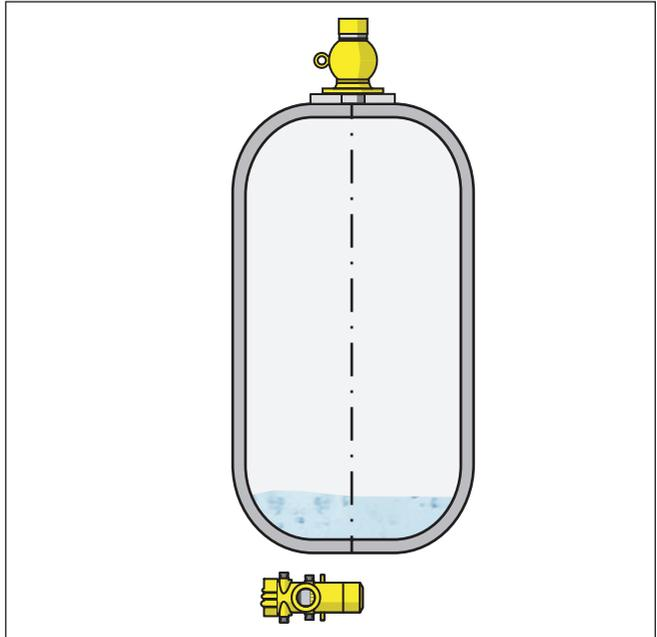
Fig. 10: Mesure de niveau - détection des quantités restantes sur une cuve de stockage
