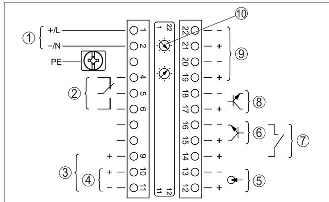
Fig. 16: Compartiment électronique et de raccordement des appareils non Ex et appareils avec sortie courant non à sécurité intrinsèque
