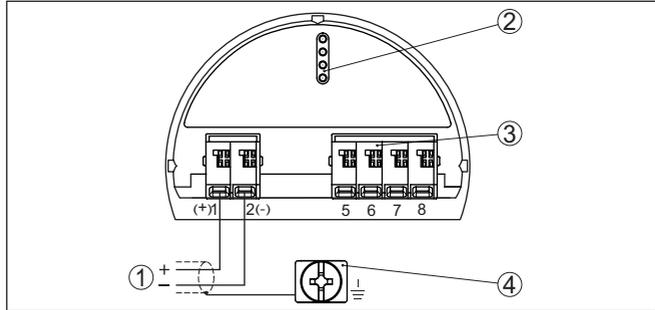
Fig. 19: Compartiment de réglage et de raccordement (Ex ia) des appareils avec sortie courant à sécurité intrinsèque
