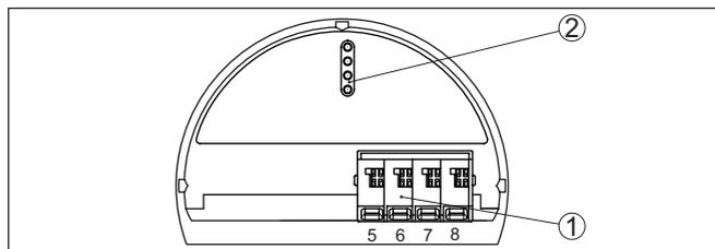
Fig. 17: Compartiment de réglage et de raccordement des appareils non Ex et appareils avec sortie courant non à sécurité intrinsèque
