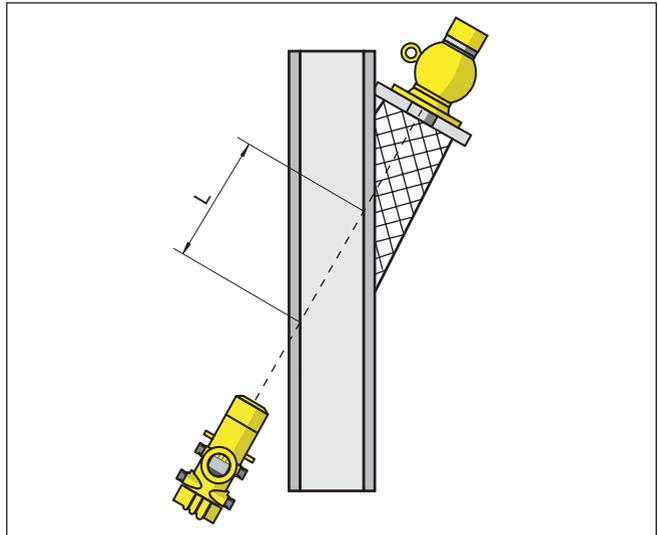
Fig. 23: Pour le montage incliné, la longueur pénétrée du tube est valable.
