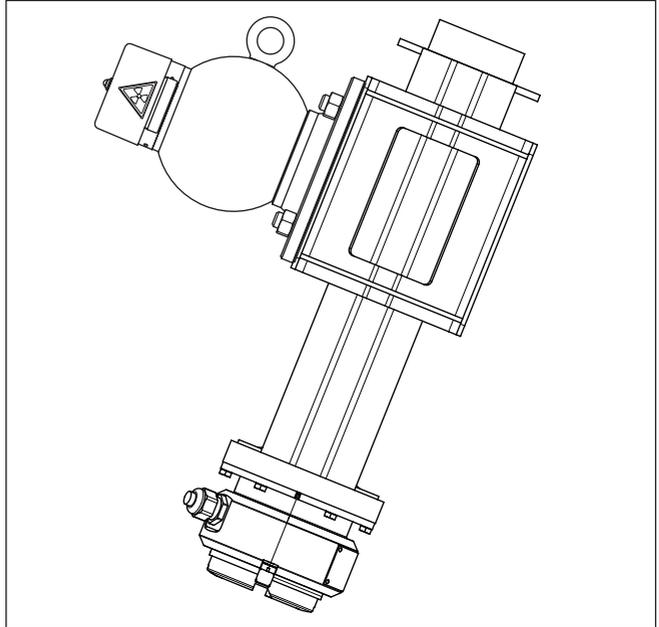
*Fig. 4: Modulateur gamma (en option) pour une mesure sans interruption même en cas de rayonnement parasite*
