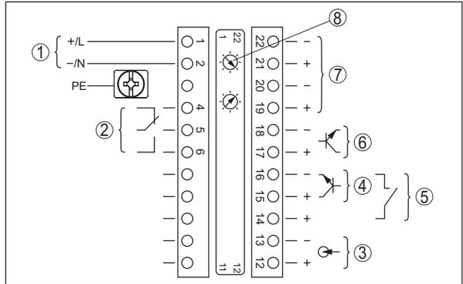
Fig. 18: Compartiment électronique et de raccordement (Ex d) des appareils avec sortie courant à sécurité intrinsèque
