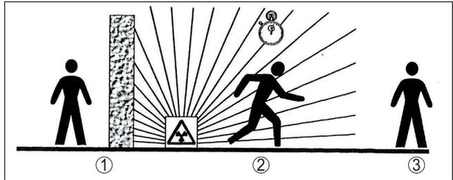
Fig. 5: Mesures de protection contre le rayonnement radioactif
