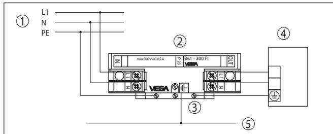
Abb. 8: Anschlussplan Überspannungsschutz B61-300 FI im Gehäuse
