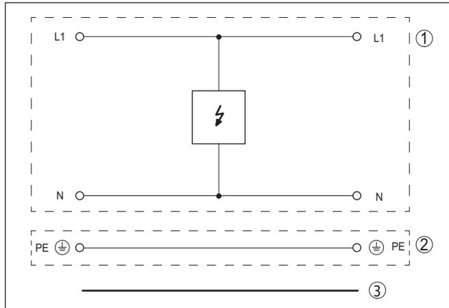
Abb. 7: Prinzipschaltbild Überspannungsschutz B61-300 FI
