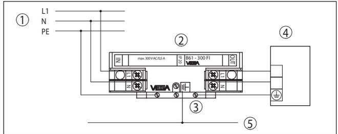
插图. 8: 电涌保护仪的接线图 B61-300 FI 位于壳体中
