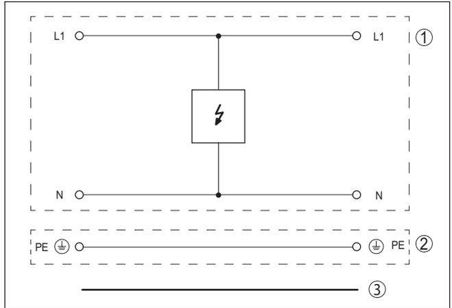
插图. 7: 电涌保护仪的连接原理图 B61-300 FI
