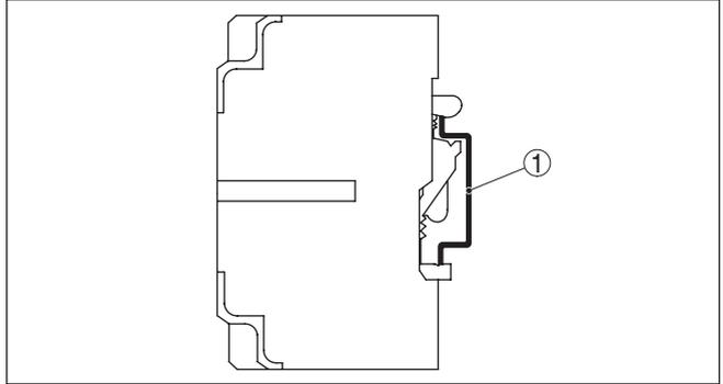
插图. 2: 安装在支撑轨道上, 根据 EN 50 022 (U 型轨道) 35 x 7.5 mm
