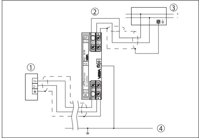
Abb. 9: Anschlussplan B62-30W - Schutz für Bussystem (Nicht-Ex-Anwendungen)
