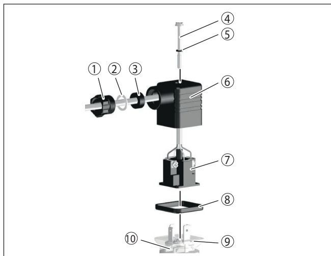
Fig. 8: Raccordement connecteur type électrovanne ISO 4400
