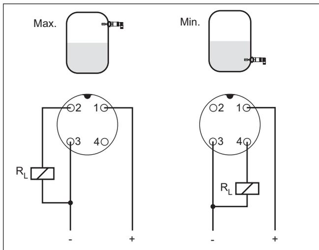
Figura 13: Schema elettrico (custodia), uscita a transistor con connettore a spina M12 x 1
