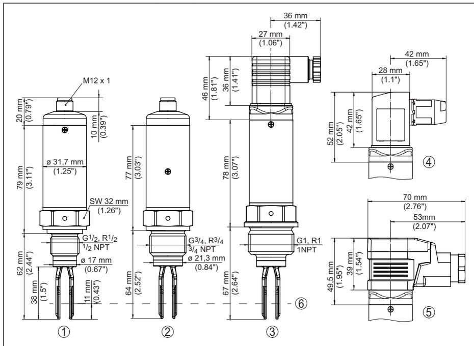
Figura 18: VEGASWING 51, esecuzione per alte temperature - attacchi filettati
