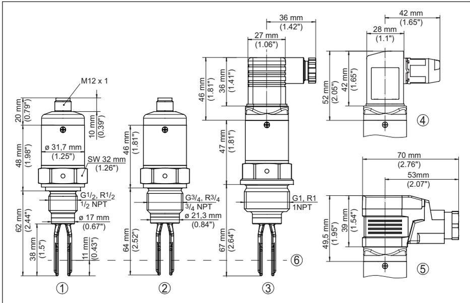
Figura 17: VEGASWING 51, esecuzione standard - attacchi filettati
