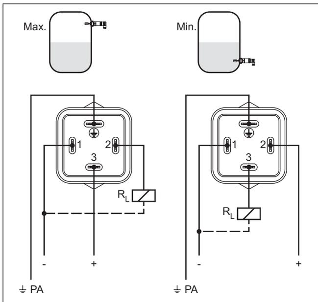
Figura 12: Schema elettrico, uscita a transistor con connettore a valvola ISO 4400
