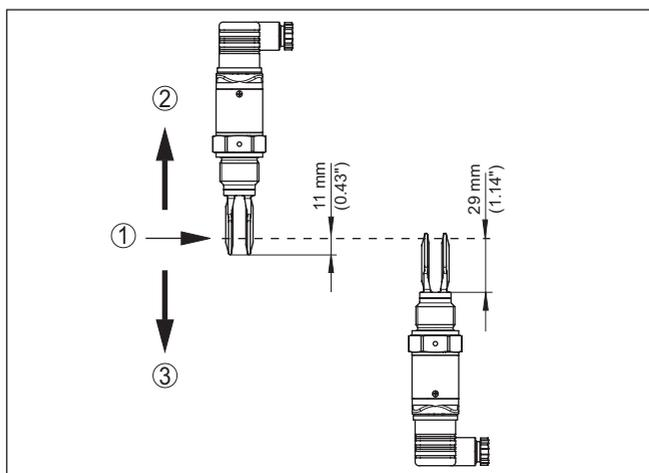
Figura 2: Montaggio verticale
