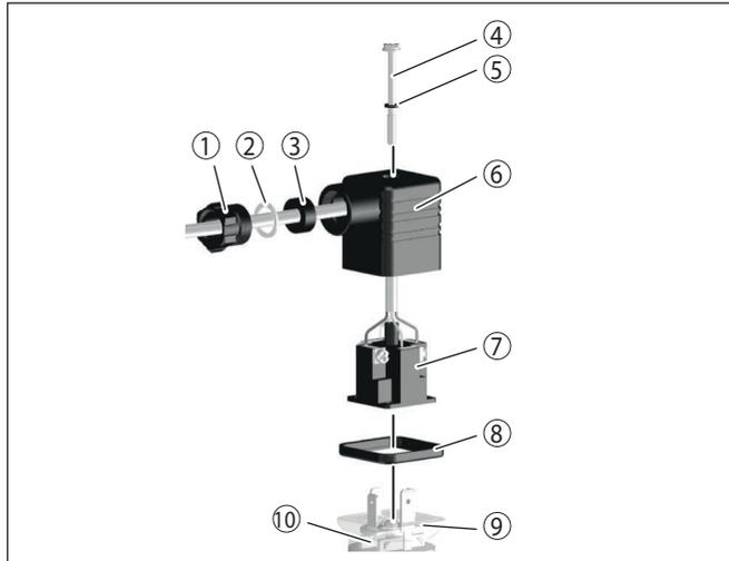
Figura 8: Collegamento del connettore a valvola ISO 4400
