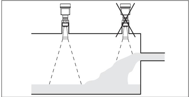
Abb. 7: Montage des Radarsensors bei einströmendem Medium
