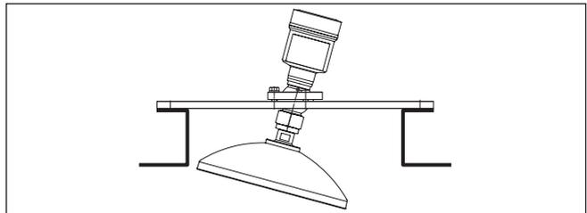
Abb. 11: Abstand zwischen Antenne und Stützen bei Parabolantenne
