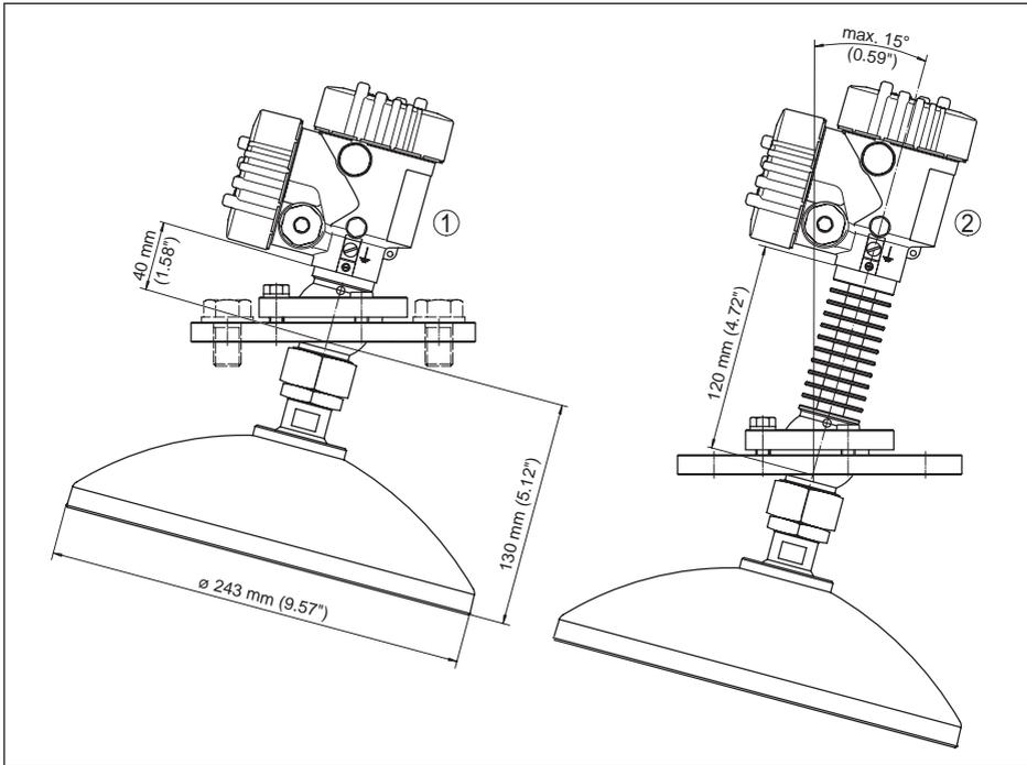
Abb. 58: VEGAPULS 62, Parabolantenne und Schwenkhalterung
