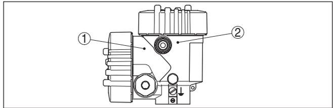
Abb. 23: Position von Versorgungs- und Elektronikraum
