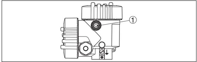
Abb. 26: Ein-/Aus-Taster außen am Gehäuse
