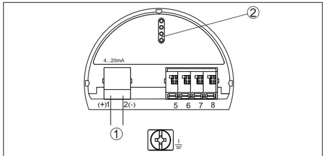
Abb. 24: Elektronikraum - Zweikammergehäuse
