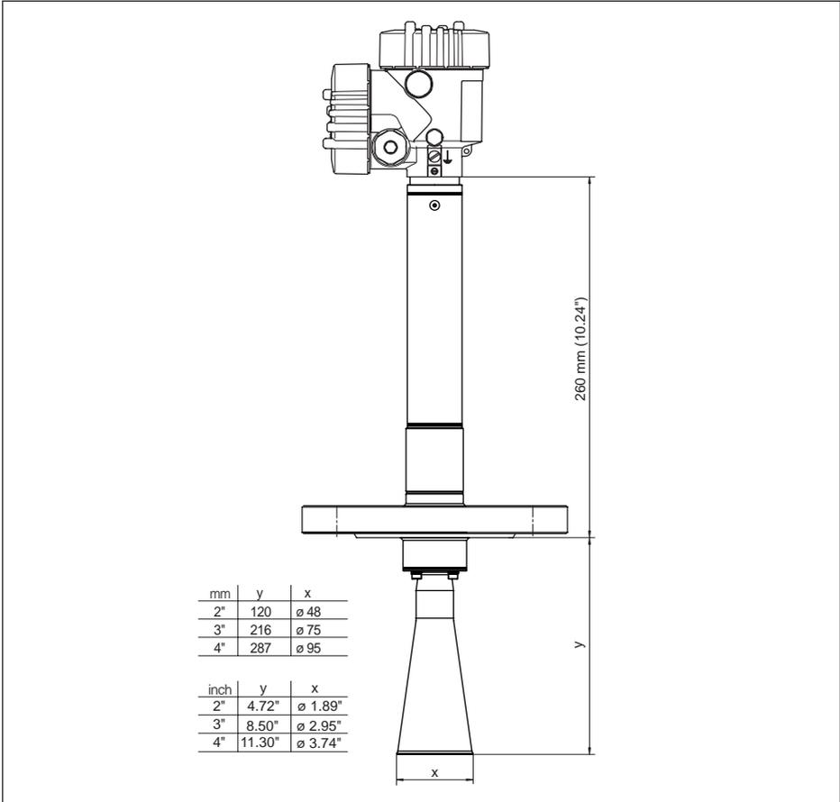
Abb. 55: VEGAPULS 62, Hornantenne in Flanschausführung mit Temperaturzwischenstück bis 450 °C
