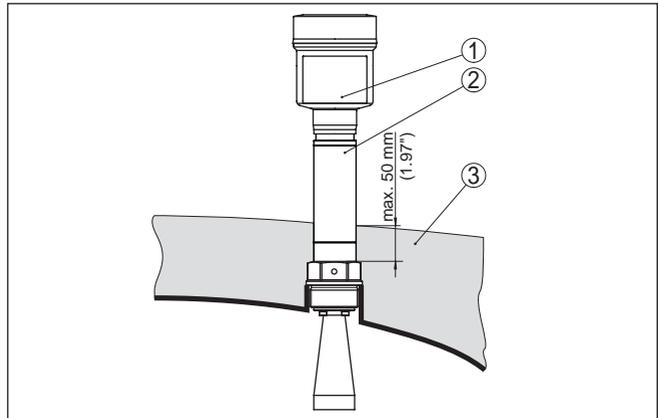
Abb. 17: Montage des Gerätes bei isolierten Behältern.
