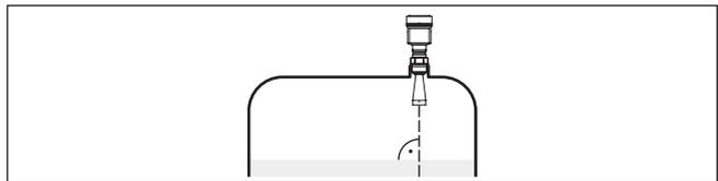
Abb. 13: Ausrichtung in Flüssigkeiten
