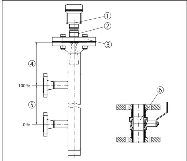
Abb. 20: Aufbau Bypass
