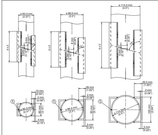
Abb. 19: Schweißverbindung bei Schwallrohrverlängerung für unterschiedliche Beispiel-Durchmesser
