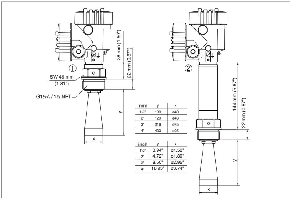
Abb. 52: VEGAPULS 62, Hornantenne in Gewindeausführung
