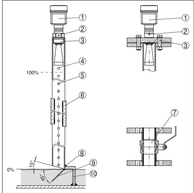
Abb. 18: Aufbau Schwallrohr VEGAPULS 62
