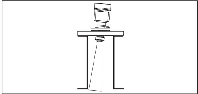
Abb. 10: Abstand zwischen Antenne und Stützen bei Hornantenne
