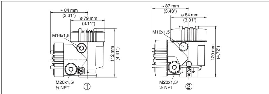
Abb. 49: Maße Gehäuse (mit eingebautem Anzeige- und Bedienmodul vergrößert sich die Gehäusehöhe um 9 mm/0.35 in, bei Metallgehäusen um 18 mm/0.71 in)
