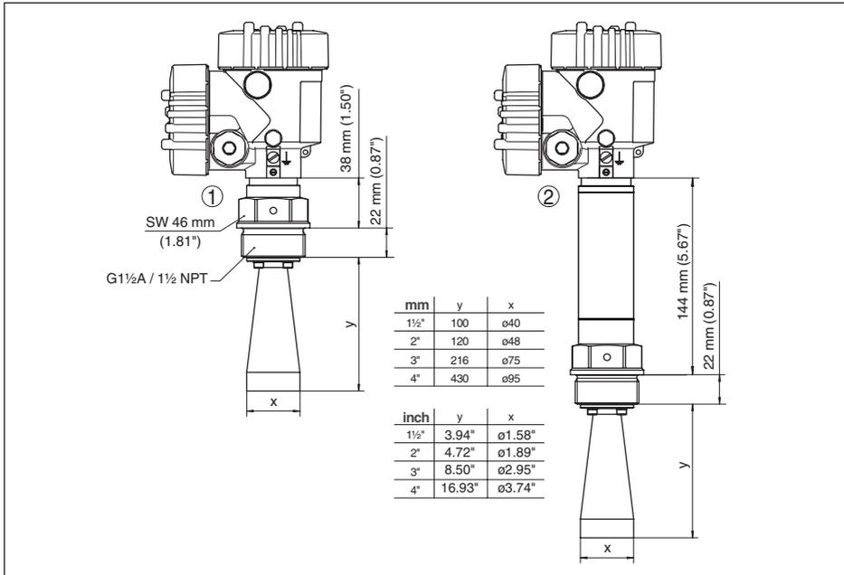
Abb. 50: VEGAPULS 68, Hornantenne in Gewindeausführung
