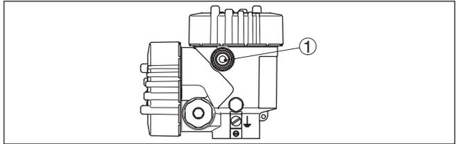
Abb. 29: Ein-/Aus-Taster außen am Gehäuse
