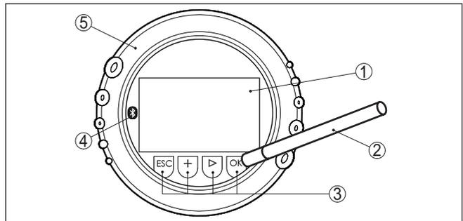
Abb. 33: Anzeige- und Bedienelemente - mit Bedienung über Magnetstift
