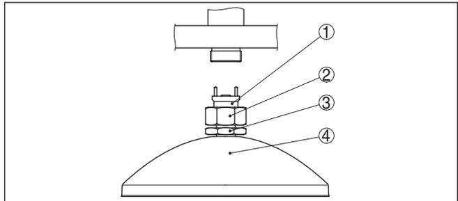
Abb. 4: Demontage Parabolantenne
