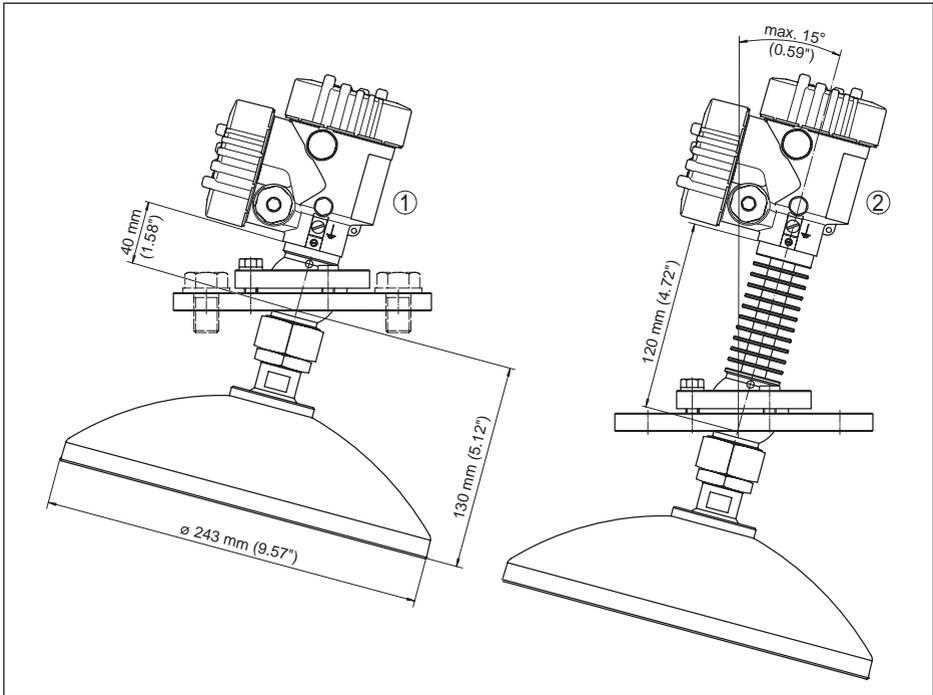
Abb. 56: VEGAPULS 68, Parabolantenne und Schwenkhalterung
