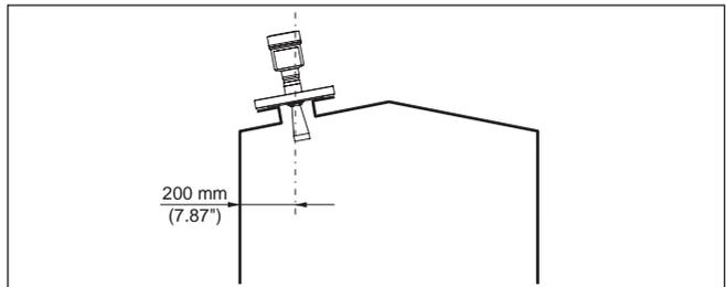
Abb. 6: Montage des Radarsensors an der Behälterdecke
