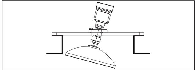
Abb. 12: Abstand zwischen Antenne und Stützen bei Parabolantenne
