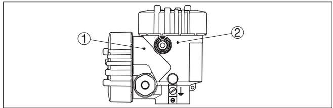
Abb. 26: Position von Versorgungs- und Elektronikaum
