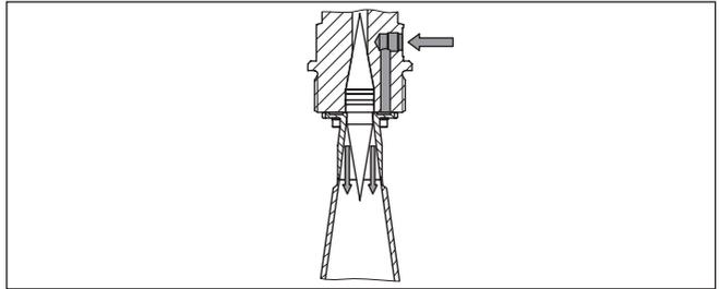
Abb. 24: Spülluftanschluss bei Hornantenne
