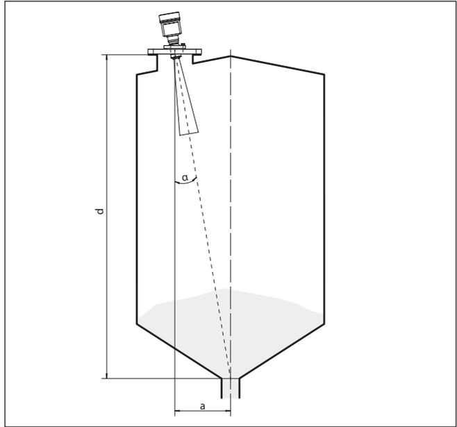
Abb. 15: Vorschlag für den Einbau nach Ausrichtung VEGAPULS 68
