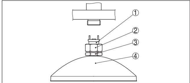
Abb. 3: Demontage Parabolantenne
