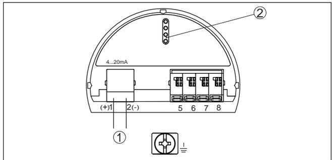
Abb. 27: Elektronikaum - Zweikammergehäuse
