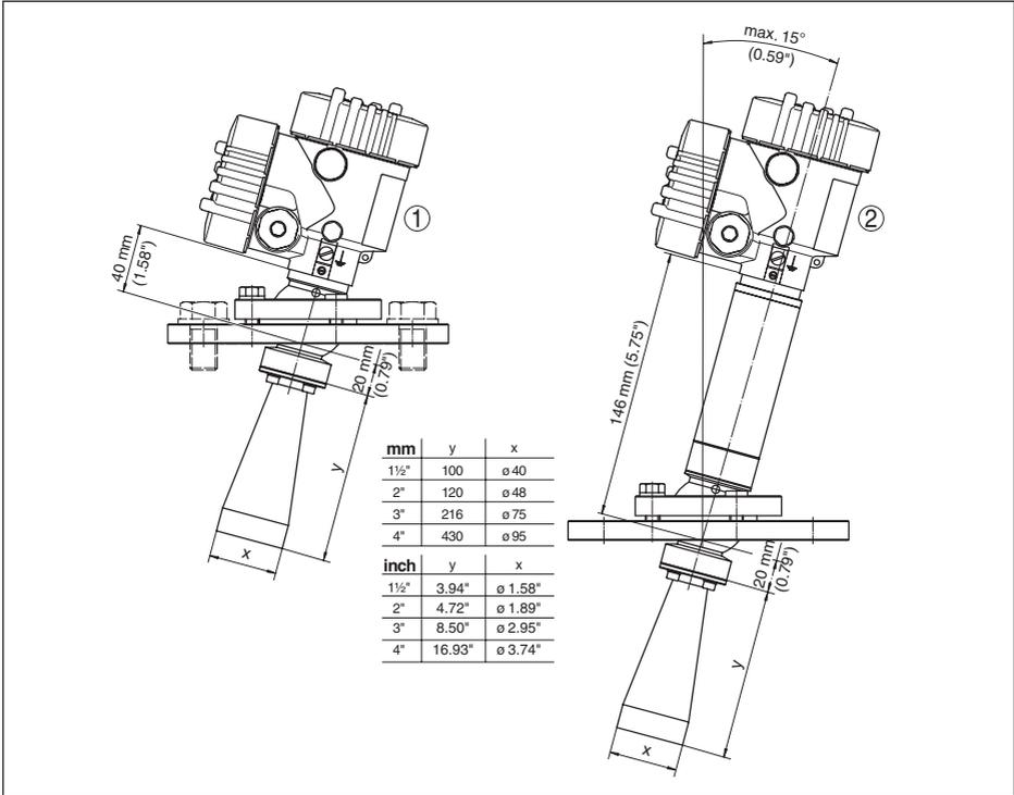
Abb. 54: VEGAPULS 68, Hornantenne und Schwenkhalterung
