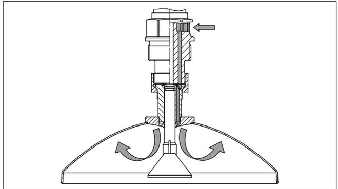
Abb. 25: Spülluftanschluss bei Parabolantenne
