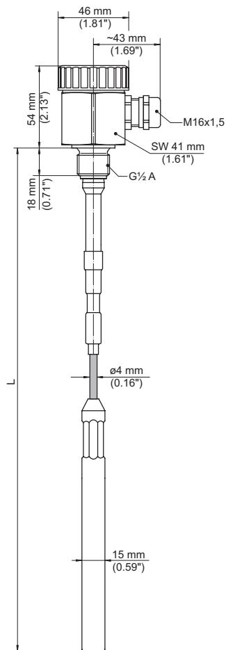
插图. 7: 导电性棒式测量探头 EL 9
