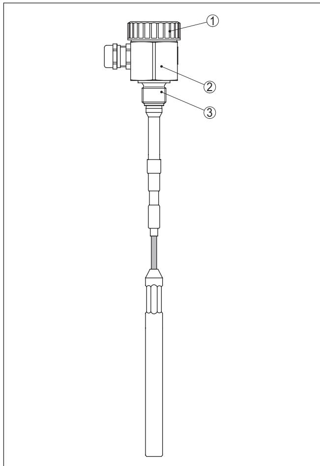
插图. 1: 导电性棒式测量探头 EL 9
