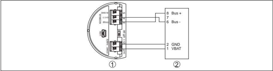
Abb. 30: Anschluss des VEGAPULS 62 an RTU ABB Total Flow
