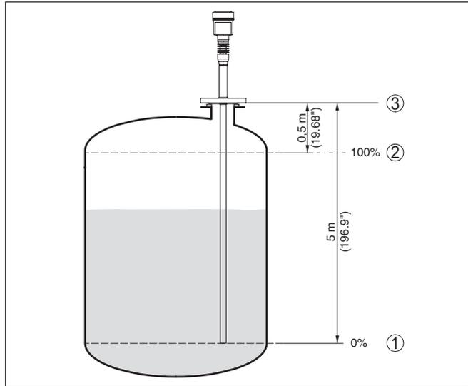
Abb. 13: Parametrierbeispiel Min.-/Max.-Abgleich
