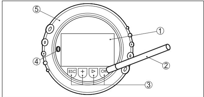
Abb. 12: Anzeige- und Bedienelemente - mit Bedienung über Magnetstift
