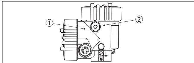
Abb. 5: Position von Anschlussraum (Modbuselektronik) und Elektronikraum (Sensorelektronik)
