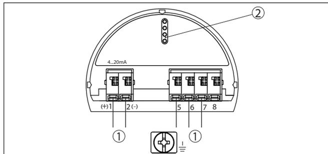
Abb. 6: Elektronikraum - Zweikammergehäuse
