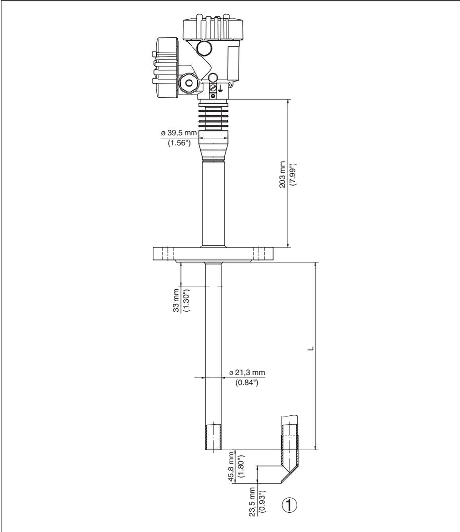
Abb. 36: VEGAPULS 62, Standrohrausführung mit Flansch<sup>9)</sup>
