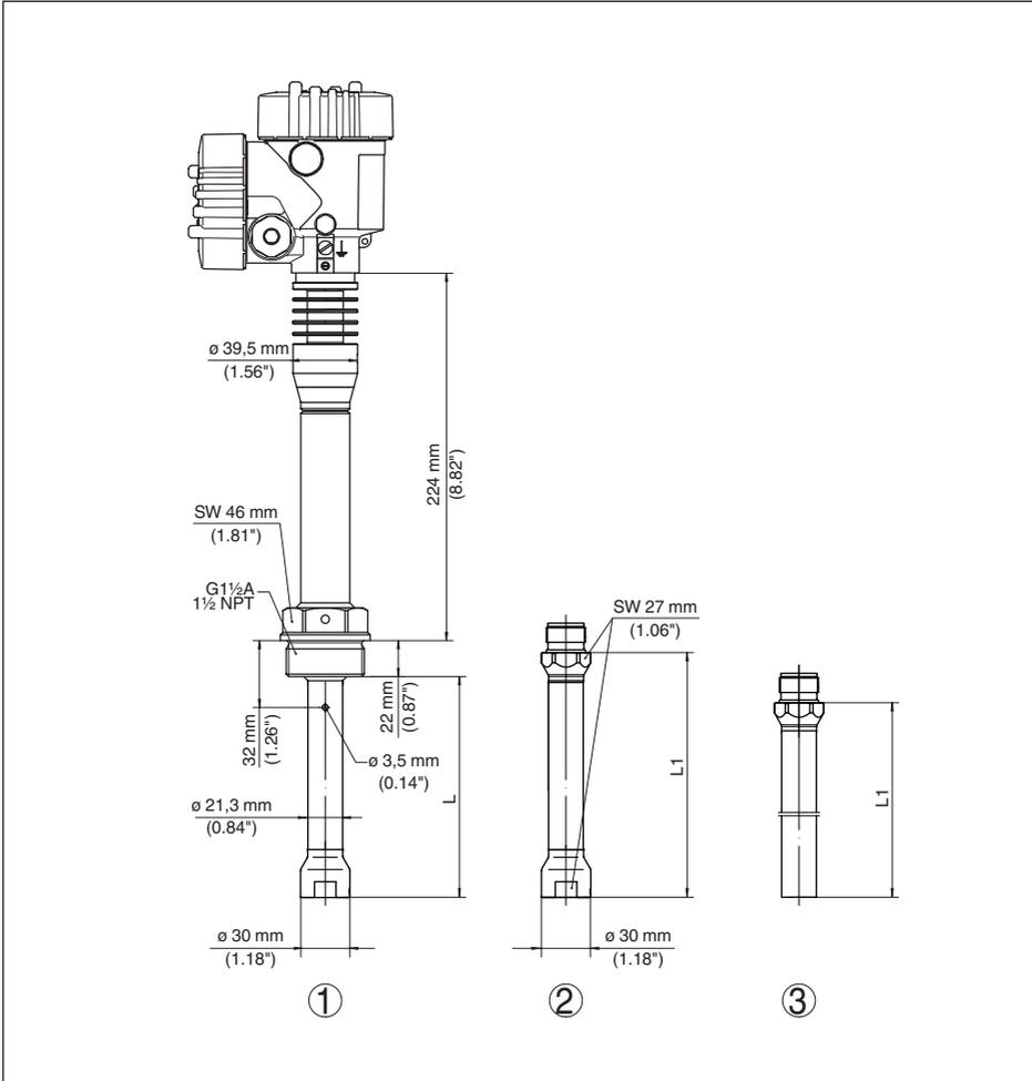
Abb. 37: VEGAPULS 62, Ausführung für Standrohrverlängerung mit Gewinde<sup>10)</sup>
