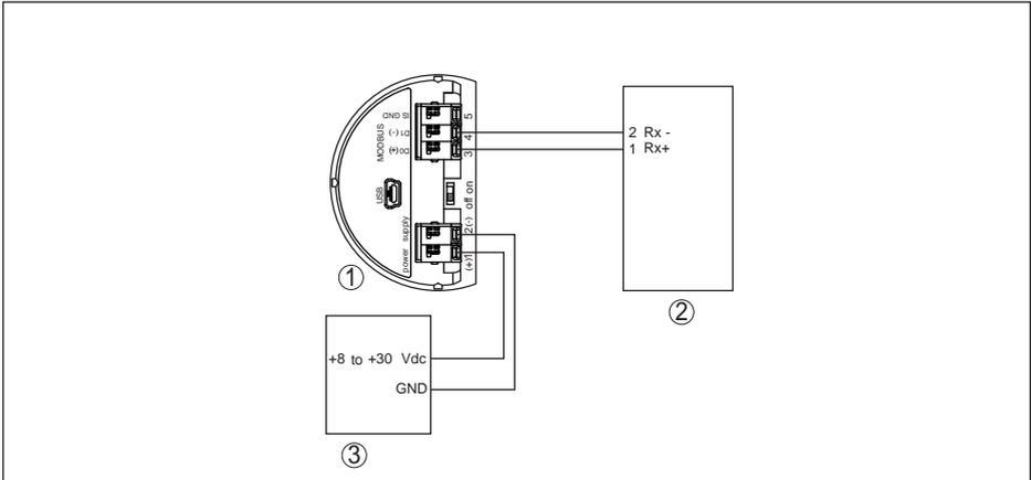
Abb. 31: Anschluss des VEGAPULS 62 an RTU Thermo Electron Autopilot
