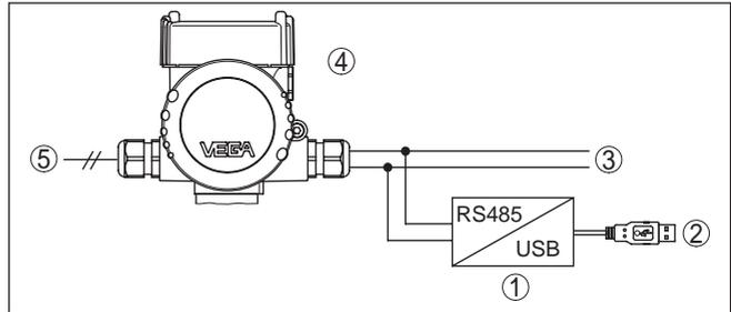
Abb. 16: Anschluss des PCs via Schnittstellenadapter an die RS 485-Leitung
