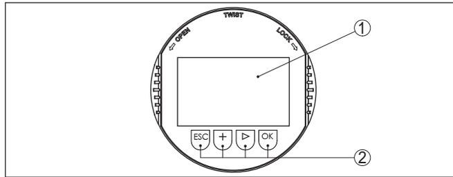
Abb. 11: Anzeige- und Bedienelemente
