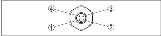
Abb. 9: Sicht auf den Steckverbinder M12 x 1
