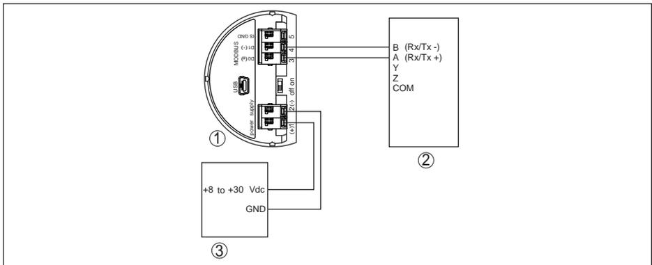
Abb. 29: Anschluss des VEGAPULS 62 an RTU Fisher ROC 809
