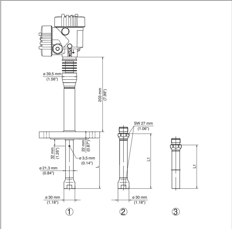
Abb. 38: VEGAPULS 62, Ausführung für Standrohrverlängerung mit Flansch<sup>1)</sup>
