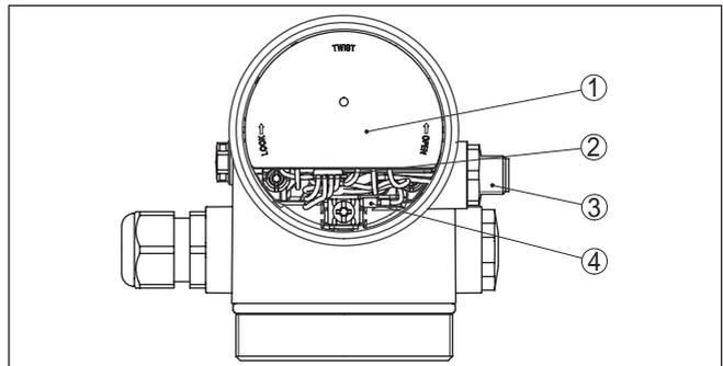
Abb. 8: Sicht auf den Elektronikraum mit VEGADIS-Adapter zum Anschluss der externen Anzeige- und Bedieneinheit
