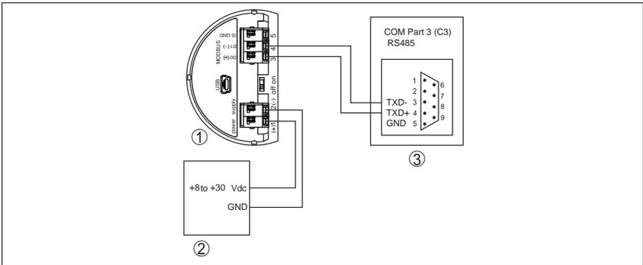
Abb. 33: Anschluss des VEGAPULS 62 an RTU ScadaPack
