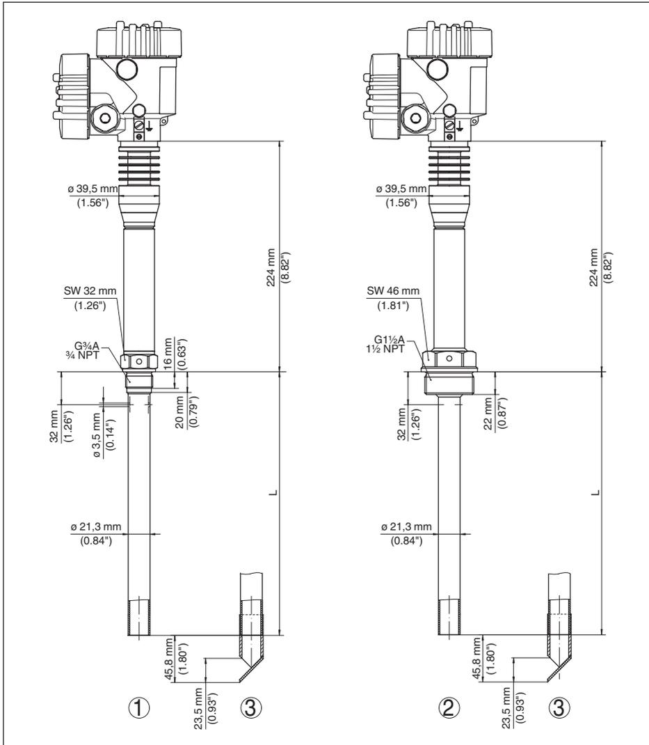
Abb. 35: VEGAPULS 62, Standrohrausführung mit Gewinde<sup>8)</sup>
