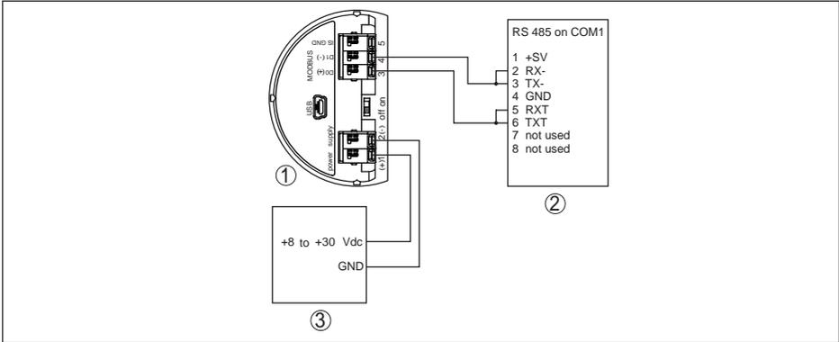
Abb. 32: Anschluss des VEGAPULS 62 an RTU Bristol ControlWave Micro
