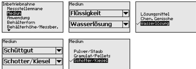
Durch diese Auswahl wird der Sensor optimal an das Produkt angepasst und die Messsicherheit vor allem bei Medien mit schlechten Reflexionseigenschaften deutlich erhöht.
