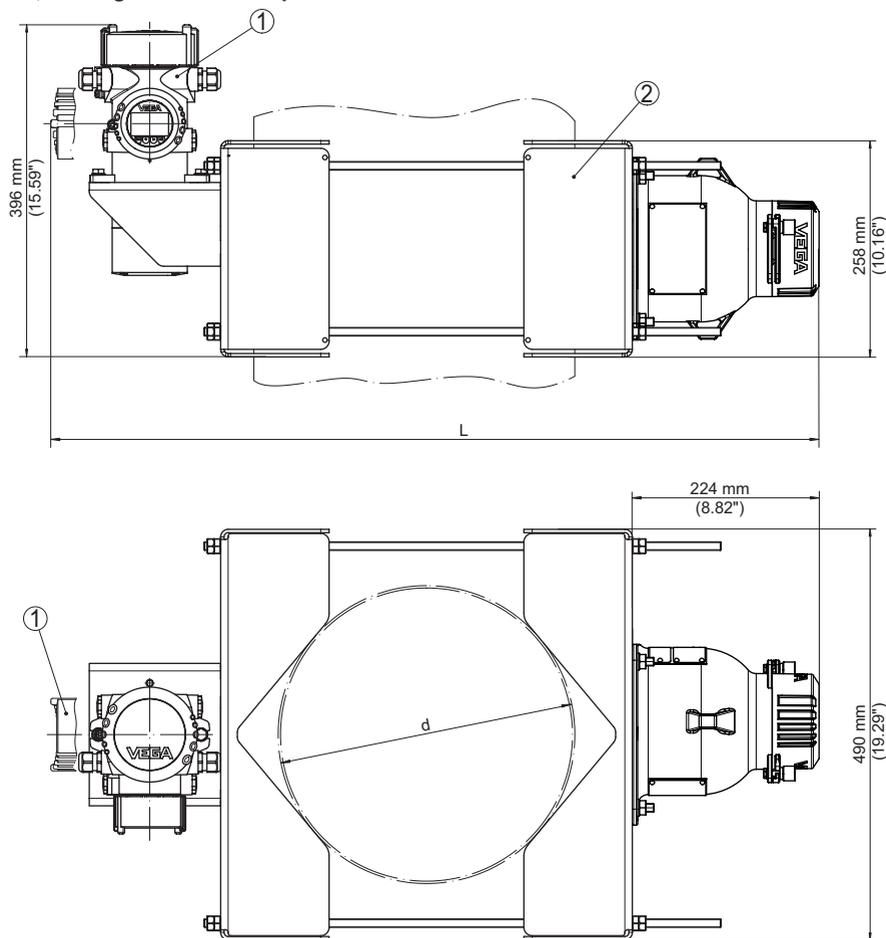
Fig. 9: Dispositif de serrage avec capteur monté verticalement (avec VEGASOURCE 81, 82)
