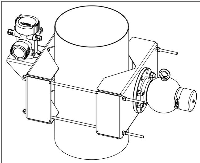
Fig. 1: Dispositif de fixation avec un capteur monté verticalement
