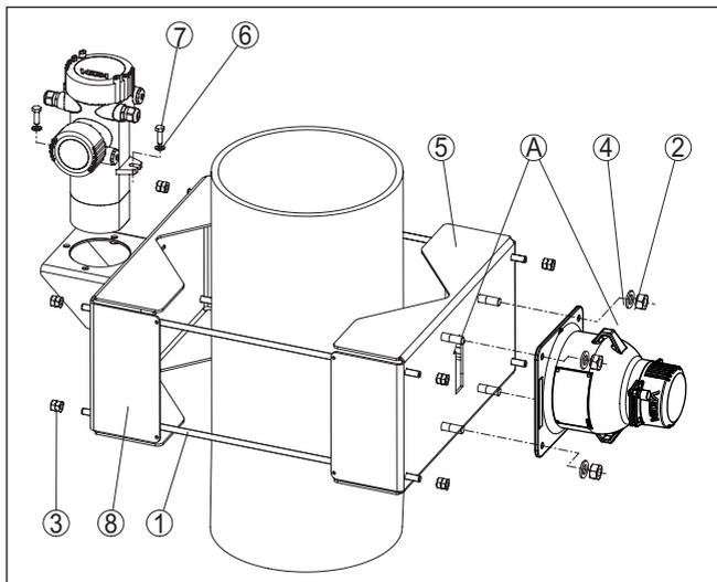
Fig. 6: Dispositif de fixation avec un capteur monté verticalement
