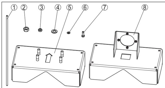
Fig. 2: Dispositif de fixation KV 31 pour conduites traversées perpendiculairement, Montage vertical du capteur
