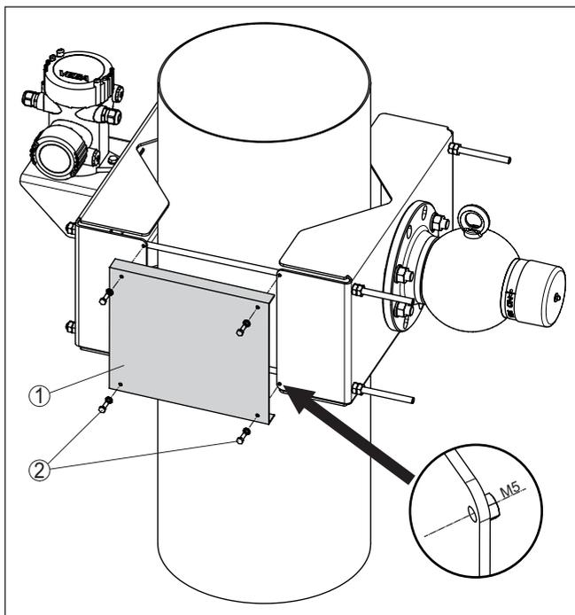
Fig. 5: Apposer une grille de protection sur les deux côtés du dispositif de fixation
