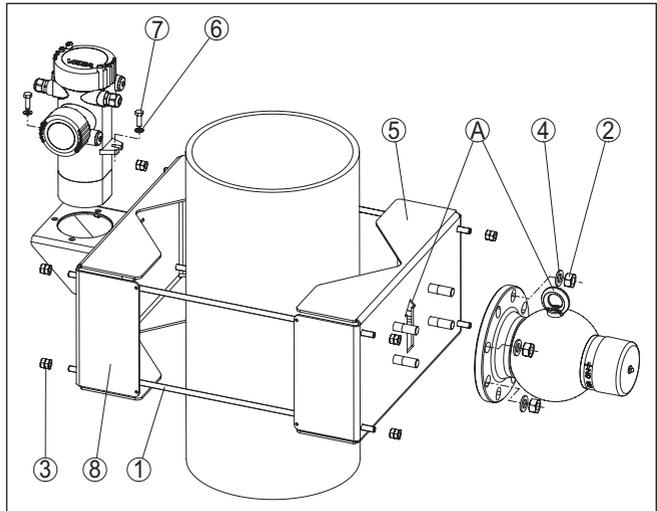
Fig. 4: Dispositif de fixation avec un capteur monté verticalement
