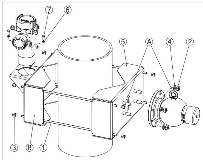
Figura 4: Dispositivo di montaggio per sensore montato verticalmente
