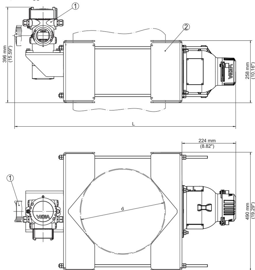
Figura 9: Dispositivo di fissaggio con sensore montato verticalmente (con VEGASOURCE 81, 82)
