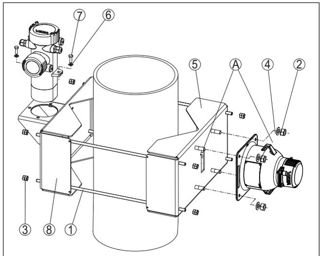
Figura 6: Dispositivo di montaggio per sensore montato verticalmente
