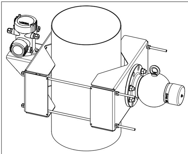
Figura 1: Dispositivo di montaggio per sensore montato verticalmente
