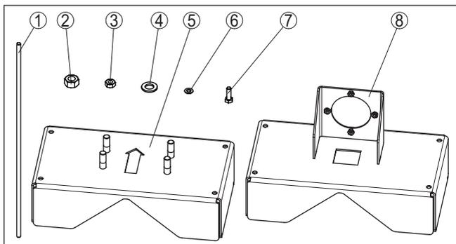
Figura 2: Dispositivo di fissaggio KV 31 per tubi a irraggiamento perpendicolare, montaggio verticale del sensore
