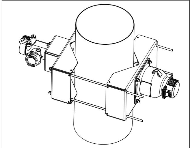
Figura 3: Dispositivo di fissaggio con sensore montato orizzontalmente
