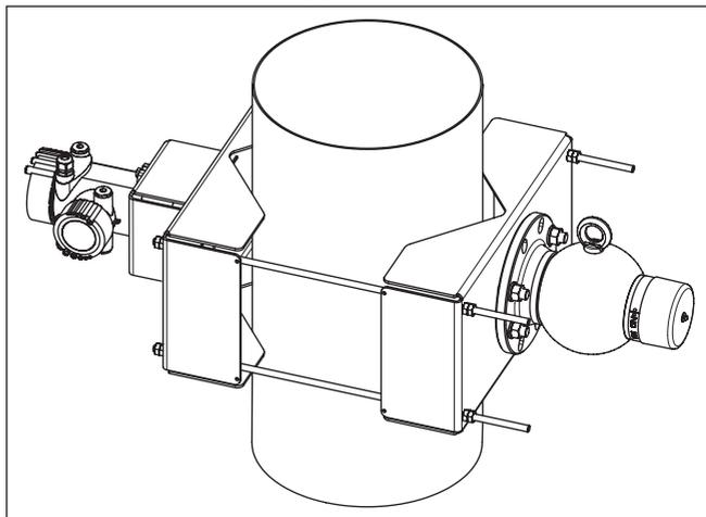
Figura 1: Dispositivo di fissaggio con sensore montato orizzontalmente
