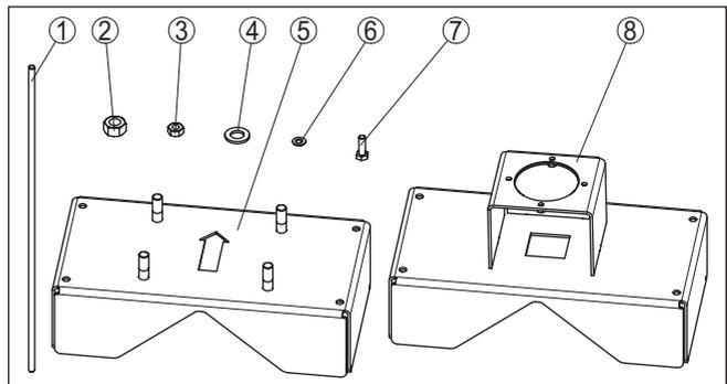
Figura 4: Dispositivo di fissaggio KV 31 per tubi a irraggiamento perpendicolare, montaggio orizzontale del sensore
