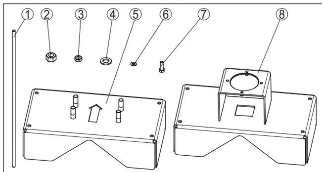
Figura 2: Dispositivo di fissaggio KV 31 per tubi a irraggiamento perpendicolare, montaggio orizzontale del sensore
