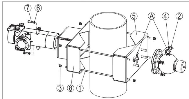
Figura 5: Dispositivo di fissaggio con sensore montato orizzontalmente
