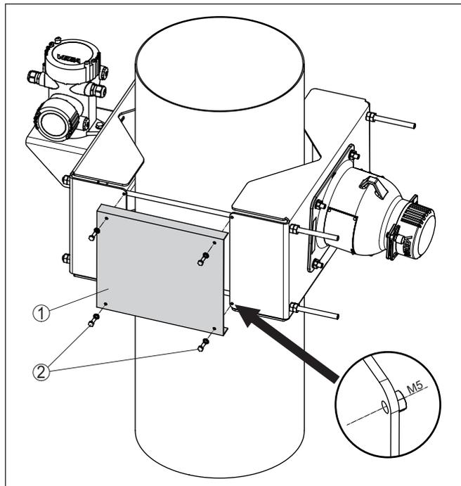
Figura 9: Applicare una grata protettiva ad ambo i lati del dispositivo di fissaggio
