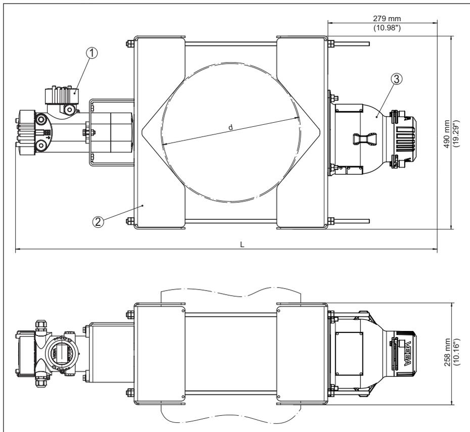
Figura 14: Dispositivo di fissaggio con sensore montato orizzontalmente (con VEGASOURCE 81, 82)
