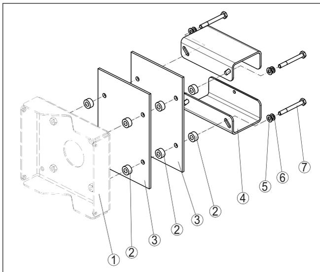
Figura 7: Montaggio delle piastre termoisolanti
