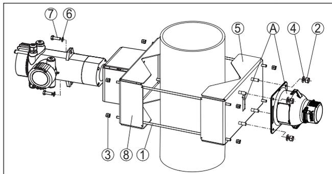
Figura 8: Dispositivo di fissaggio con sensore montato orizzontalmente
