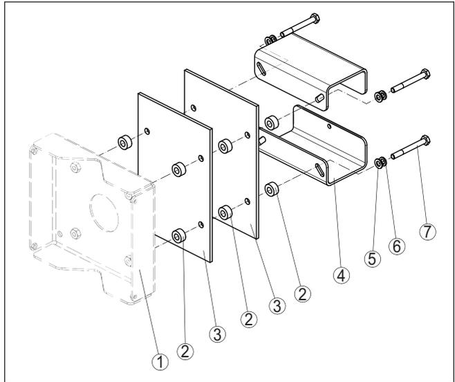
Fig. 11: Montaje de las placas de protección térmica
