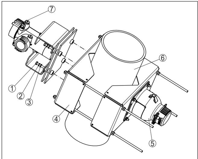
Fig. 10: Dispositivo de sujeción con protección térmica
