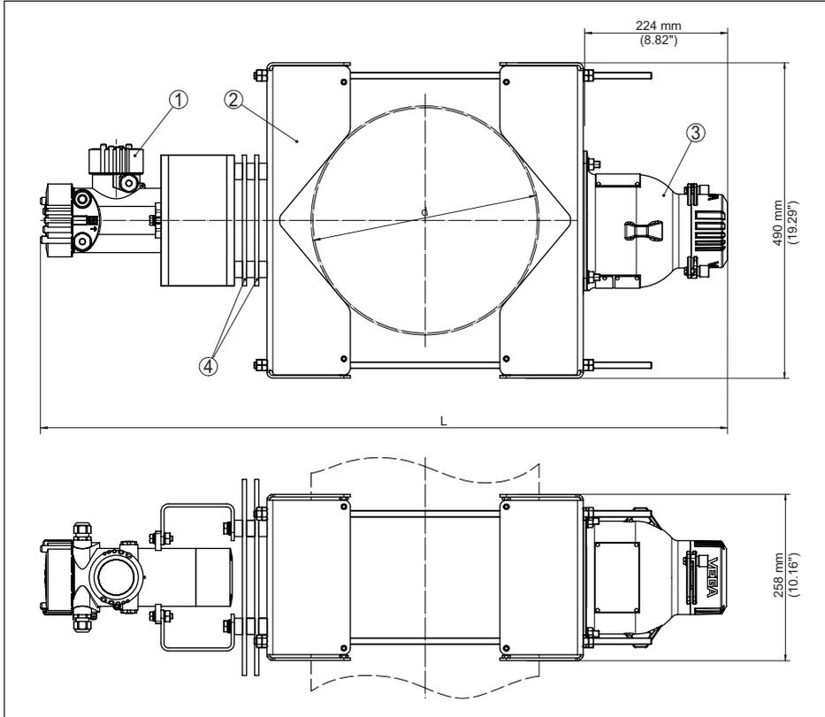
Fig. 15: Dispositivo de sujeción con sensor montado horizontalmente y kit de protección térmica (con VEGA-SOURCE 81, 82)
