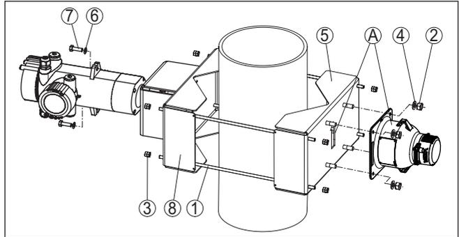
Fig. 8: Dispositivo de sujeción con sensor montado horizontalmente
