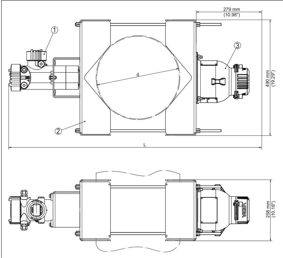
Fig. 14: Dispositivo de sujeción con sensor montado horizontalmente (con VEGASOURCE 81, 82)
