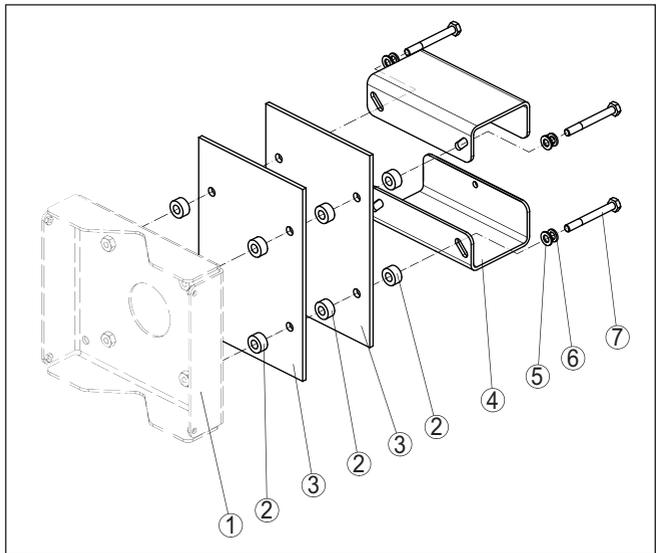
Fig. 7: Montaje de las placas de protección térmica
