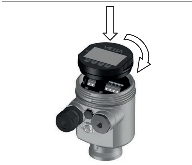
Abb. 26: Einsetzen des Anzeige- und Bedienmoduls beim Einkammergehäuse im Elektronikraum
