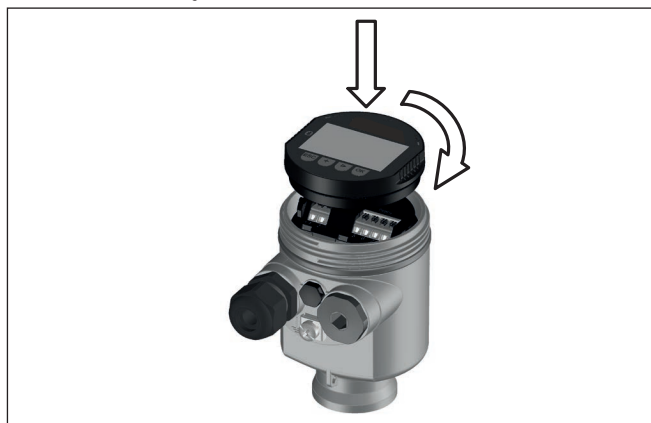
Fig. 19: Colocação do módulo de visualização e configuração na caixa de uma câmara no compartimento do sistema eletrônico
