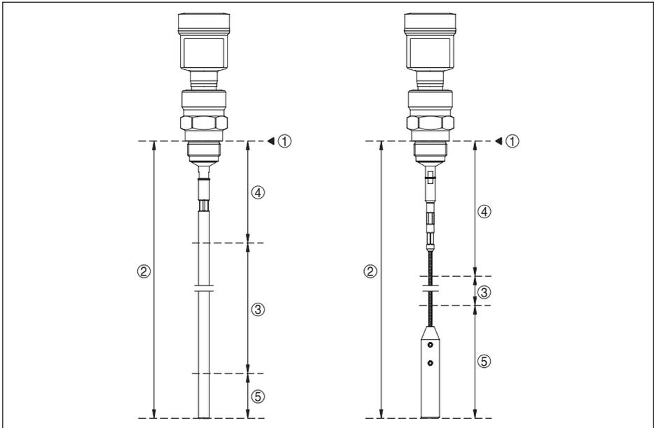
Fig. 33: Plages de mesure - VEGAFLEX 82
