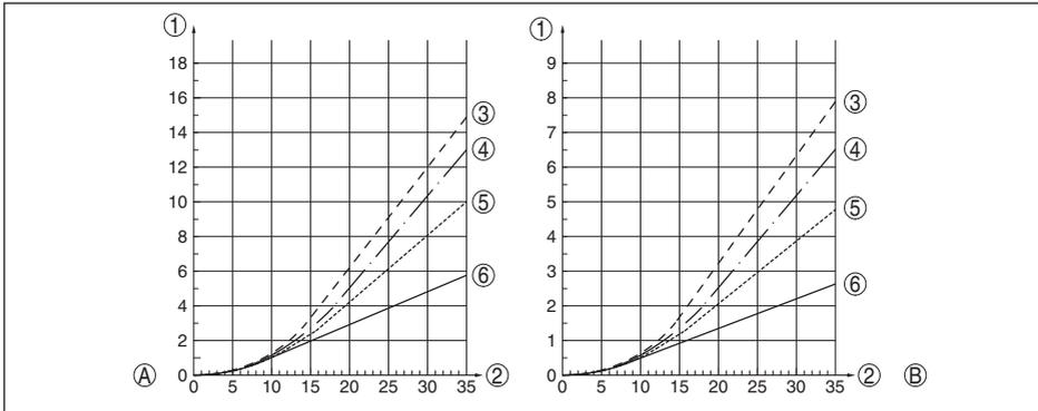
Fig. 31: Charge de traction max. avec céréales et granulés synthétiques - Câble :  $\varnothing$  6 mm,  $\varnothing$  11 mm, revêtu PA
