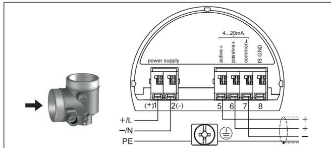
Fig. 11: Compartiment de raccordement boîtier deux chambres pour tension de réseau
