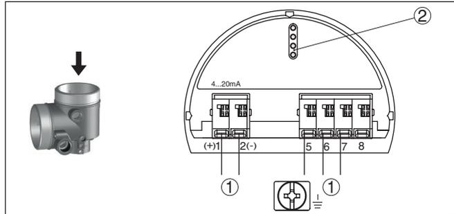
Fig. 10: Compartiment électronique - boîtier à deux chambres
