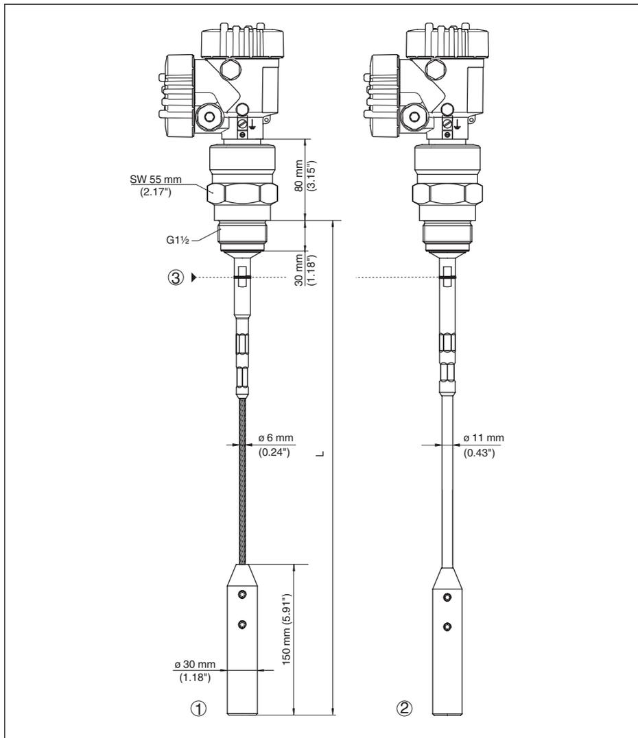
Fig. 40: VEGAFLEX 82, câble ø 6 mm (0.236 in), ø 11 mm (0.433 in) version fileté avec poids tenseur (tous les poids tenseurs avec filetage M12 pour anneau de levage)
