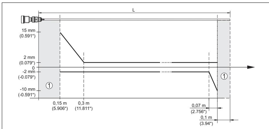
Fig. 34: Écart de mesure VEGAFLEX 82 en version tige
