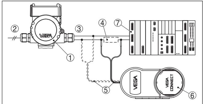
Fig. 22: Raccordement du PC à la ligne signal via HART
