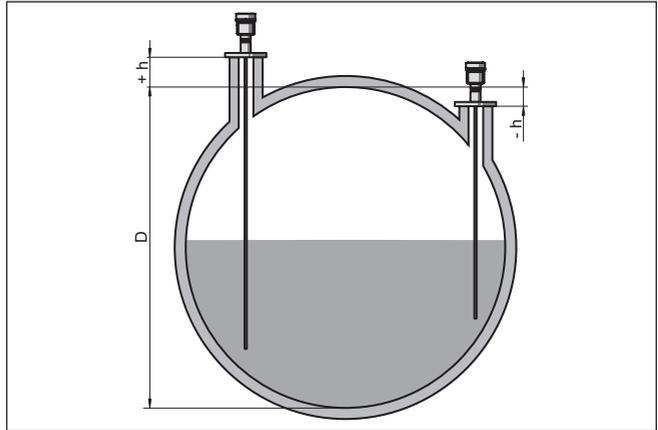
Fig. 18: Hauteur de la cuve et valeur de correction du manchon
