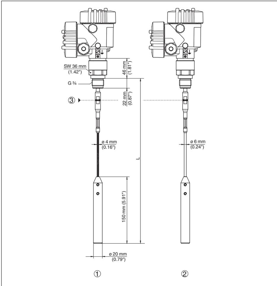
Fig. 39: VEGAFLEX 82, câble ø 4 mm (0.157 in), ø 6 mm (0.236 in) version fileté avec poids tenseur (tous les poids tenseurs avec filetage M12 pour anneau de levage)
