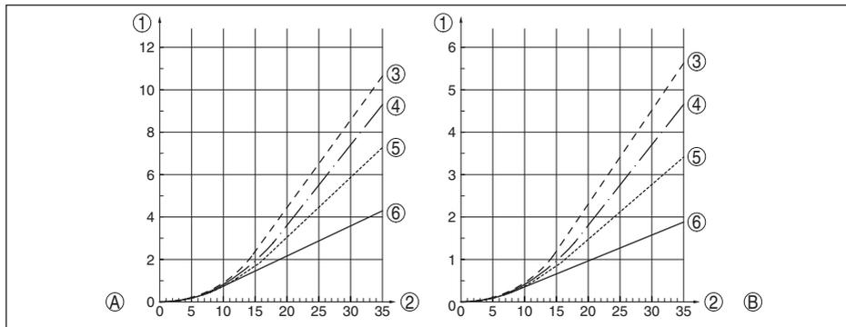
Fig. 29: Charge de traction max. avec céréales et granulés synthétiques - Câble :  $\varnothing$  4 mm (0.157 in)
