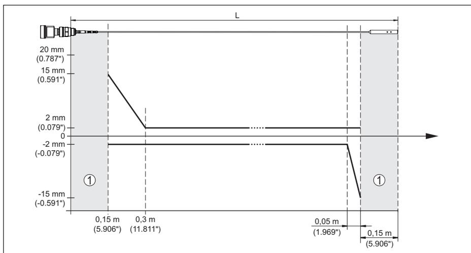
Fig. 35: Écart de mesure VEGAFLEX 82 en version câble
