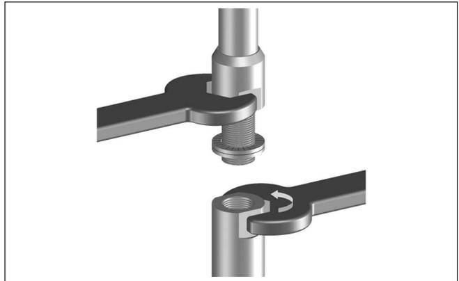
Fig. 27: Changer le câble de mesure ou la tige de mesure
