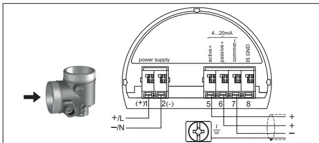
Fig. 12: Compartiment de raccordement boîtier deux chambres pour très basse tension
