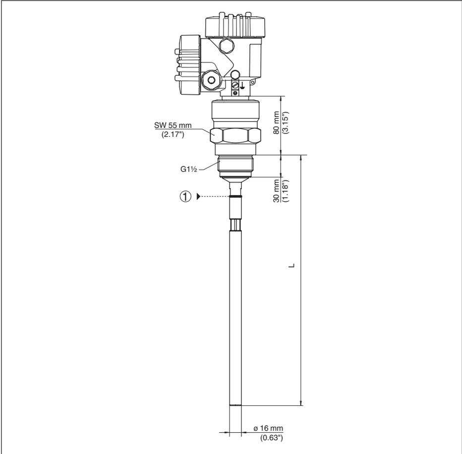
Fig. 41: VEGAFLEX 82, tige ø 16 mm (0.63 in), version filetée
