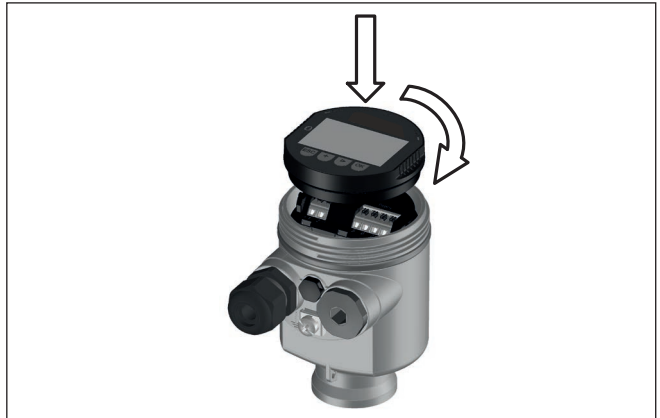
Abb. 20: Einsetzen des Anzeige- und Bedienmoduls beim Einkammergehäuse im Elektronikraum
