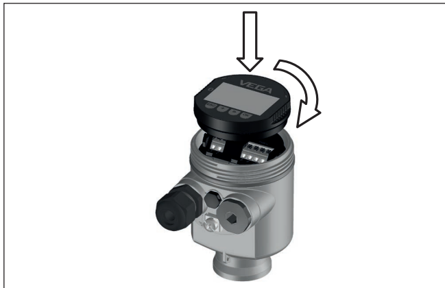
Abb. 21: Einsetzen des Anzeige- und Bedienmoduls beim Einkammergehäuse im Elektronikraum
