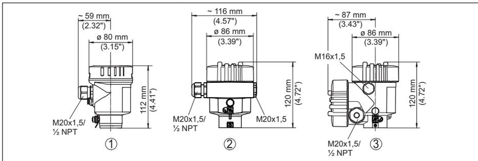
Figura 42: *Differenti custodie con grado di protezione IP66/IP68 (0,2 bar), (con tastierino di taratura con display incorporato l'altezza della custodia aumenta di 18 mm/0.71 in)*
