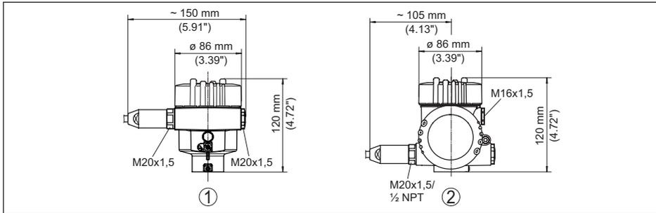
Figura 41: *Differenti custodie con grado di protezione IP66/IP68 (1 bar), (con tastierino di taratura con display incorporato l'altezza della custodia aumenta di 18 mm/0.71 in)*
