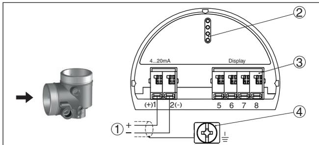
Figura 12: Vano di allacciamento - custodia a due camere
