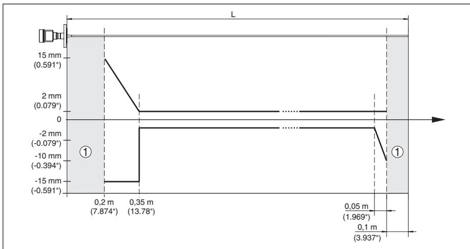
Figura 35: Scostamento di misura VEGAFLEX 83 in esecuzione a barra (rivestita) in olio
