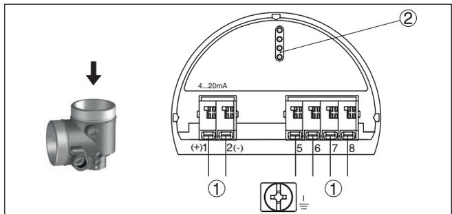
Figura 11: Vano dell'elettronica - custodia a due camere
