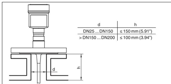
Figura 5: Tronchetto di montaggio
