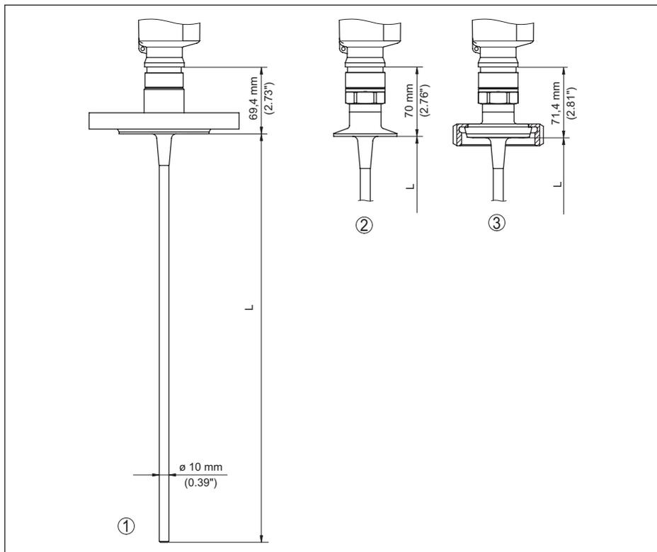
Figura 45: VEGAFLEX 83, esecuzione a barra
