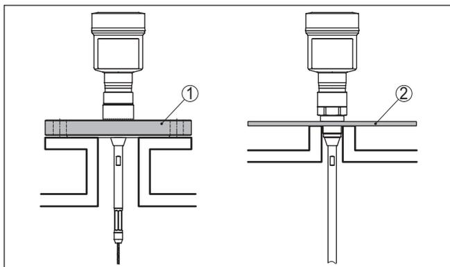
Figura 4: Montaggio in serbatoio non metallico
