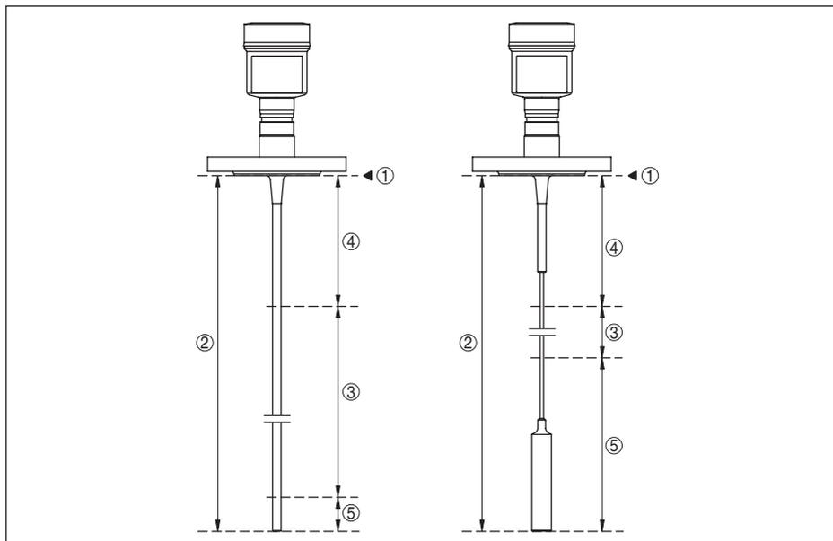
Figura 33: Campi di misura - VEGAFLEX 83
