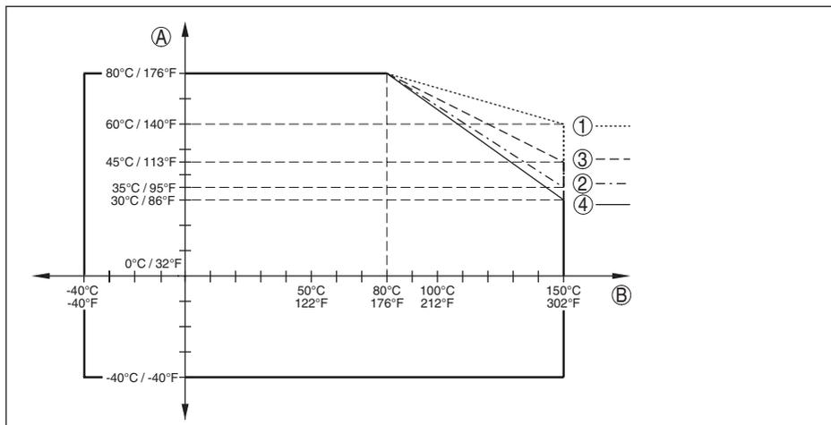
Figura 38: Temperatura ambiente - temperatura di processo, esecuzione standard
