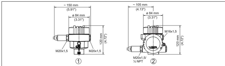
Figura 43: *Differenti custodie con grado di protezione IP66/IP68 (1 bar), (con tastierino di taratura con display incorporato l'altezza della custodia aumenta di 18 mm/0.71 in)*
