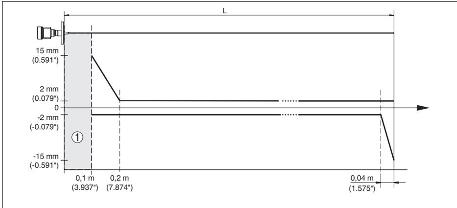
Figura 34: Scostamento di misura VEGAFLEX 83 in esecuzione a barra (rivestita) in acqua
