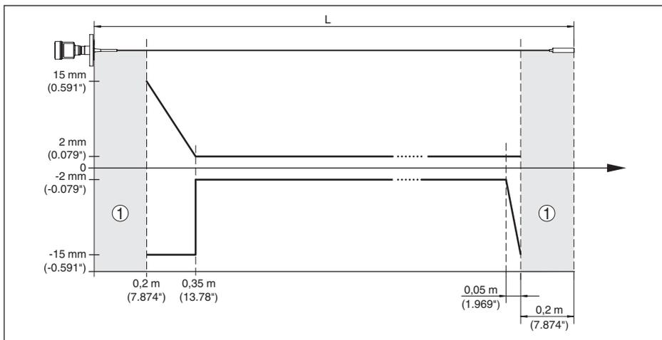
Figura 37: Scostamento di misura VEGAFLEX 83 in esecuzione a fune (rivestita) in olio
