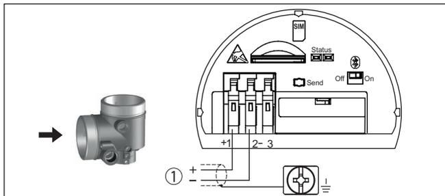
Figura 13: Vano di connessione - modulo radio PLICSMOBILE 81
