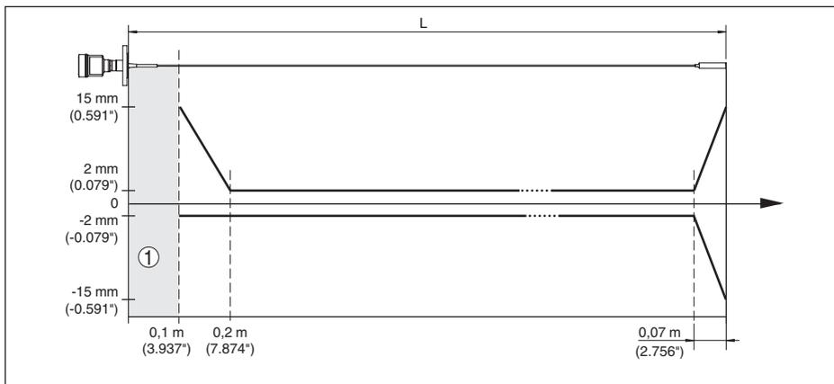
Figura 36: Scostamento di misura VEGAFLEX 83 in esecuzione a funne (rivestita) in acqua
