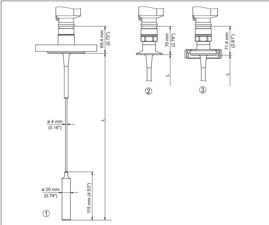
Figura 44: VEGAFLEX 83, esecuzione a fune con peso tenditore
