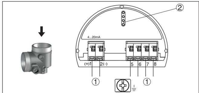
Abb. 12: Elektronikraum - Zweikammergehäuse
