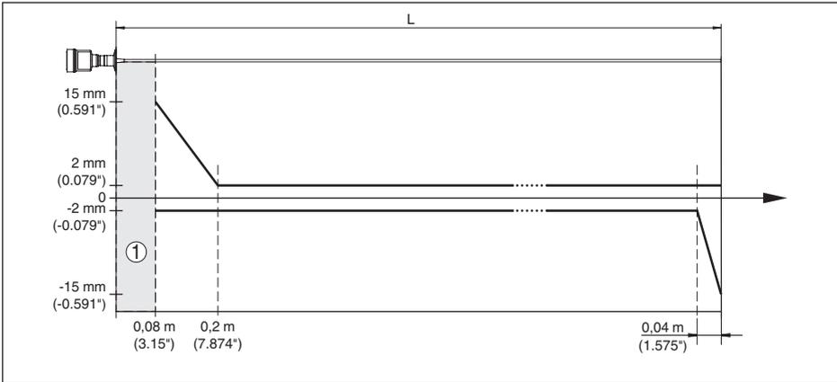
Abb. 36: Messabweichung VEGAFLEX 83 in Stabausführung in Medium Wasser
