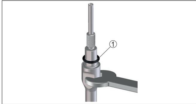
Abb. 32: Messstab wechseln
