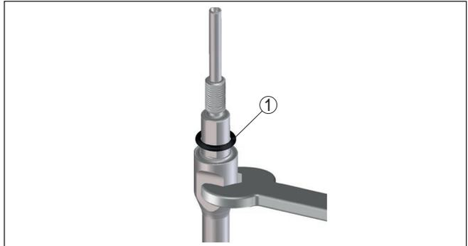
Abb. 33: Messstab ausbauen
