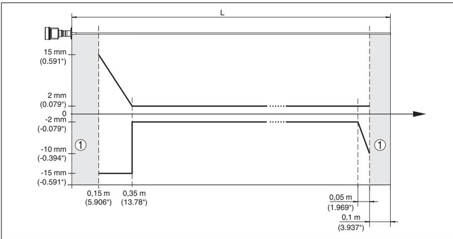
Abb. 37: Messabweichung VEGAFLEX 83 in Stabausführung in Medium Öl
