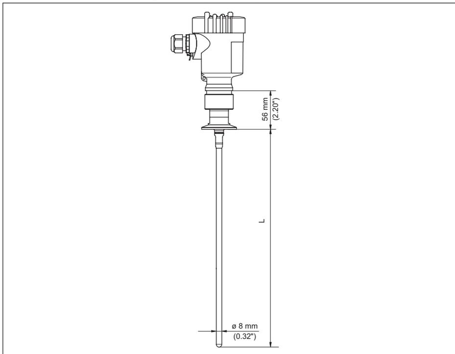
Abb. 44: VEGAFLEX 83, Stabausführung ø 8 mm (0.315 in), poliert
