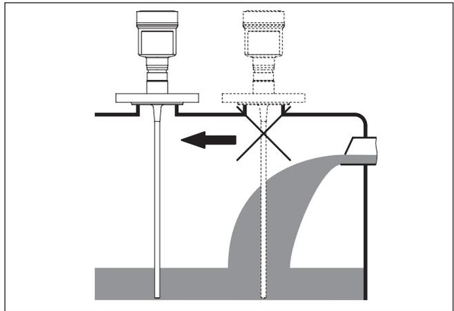
Abb. 8: Montage des Sensors bei einströmendem Medium
