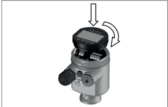
Abb. 13: Einsetzen des Anzeige- und Bedienmoduls beim Einkammergehäuse im Elektronikraum
