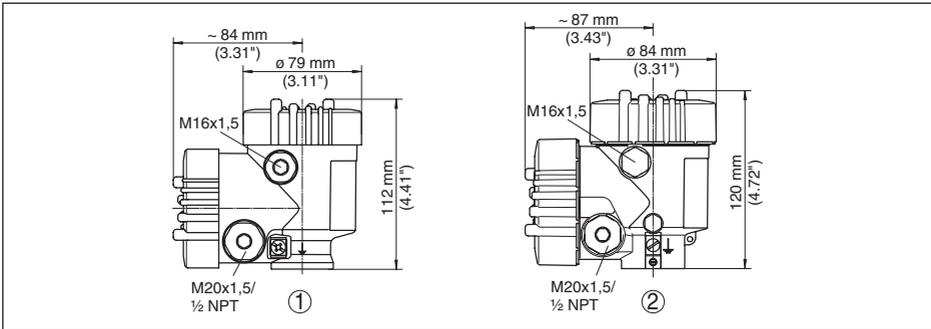
Abb. 30: Maße Gehäuse (mit eingebautem Anzeige- und Bedienmodul vergrößert sich die Gehäusehöhe um 9 mm/0.35 in)
