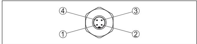
Abb. 13: Sicht auf den M12 x 1-Steckverbinder
