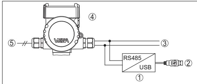
Abb. 19: Anschluss des PCs via Schnittstellenadapter an die RS 485-Leitung
