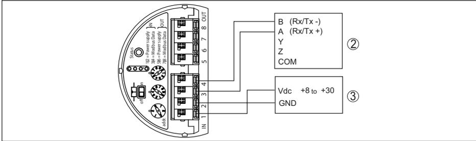
Abb. 29: Anschluss des VEGAFLEX 81 an RTU Fisher ROC 809
