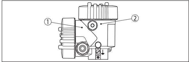
Abb. 9: Position von Anschlussraum (Modbuselektronik) und Elektronikraum (Sensorelektronik)
