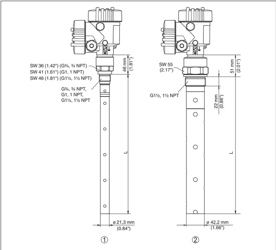
Abb. 31: VEGAFLEX 81, Gewindeausführung
