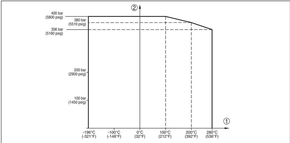
Abb. 37: Prozessdruck - Prozesstemperatur (Ausführung -196 ... +280 °C/-321 ... +536 °F)
