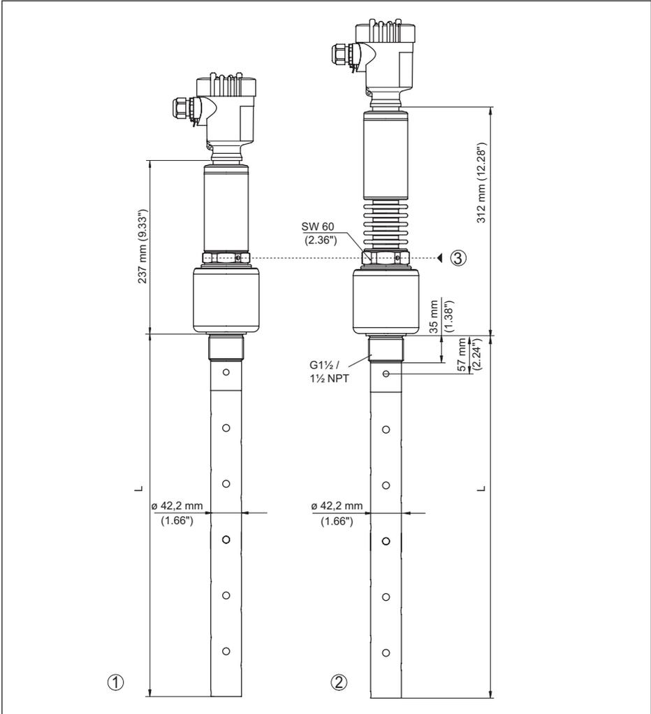
Abb. 44: VEGAFLEX 86, Gewindeausführung
