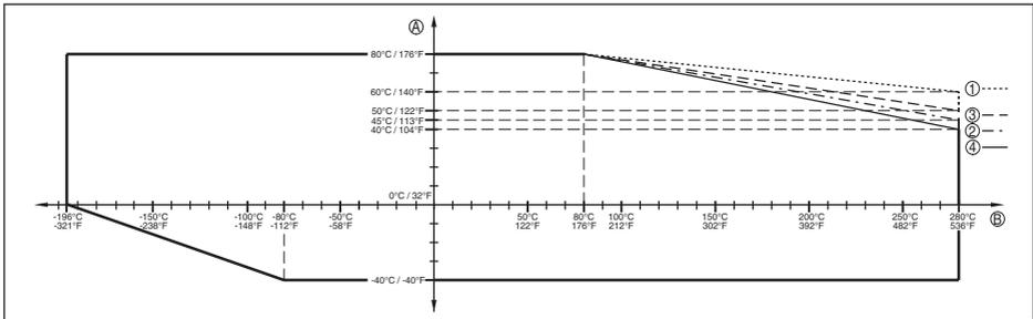
Abb. 35: Umgebungstemperatur - Prozesstemperatur, Standardausführung
