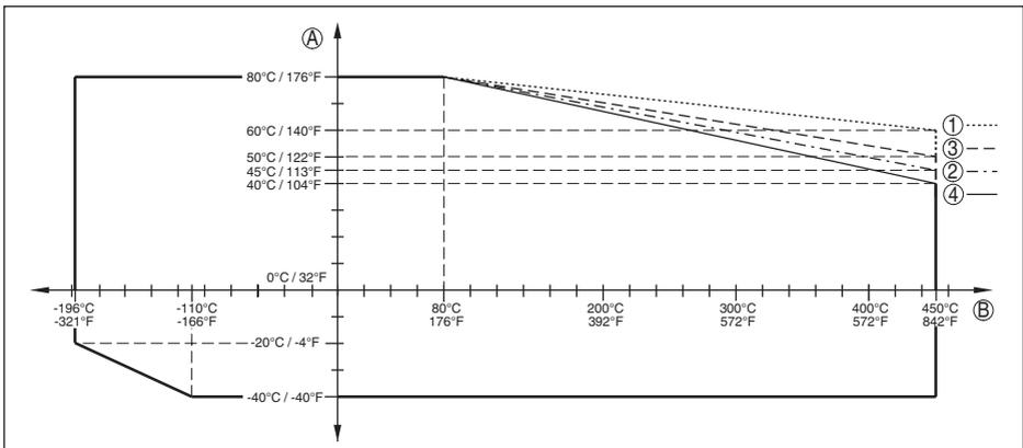
Abb. 36: Umgebungstemperatur - Prozesstemperatur, Standardausführung
