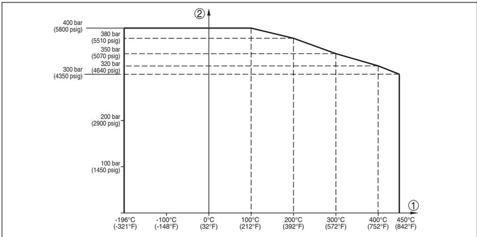
Abb. 38: Prozessdruck - Prozesstemperatur (Ausführung -196 ... +450 °C/-321 ... +842 °F)
