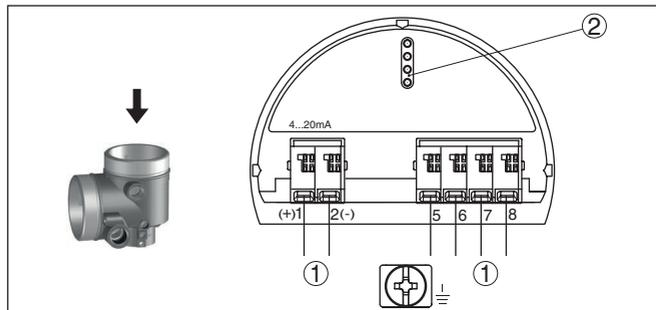
Abb. 11: Elektronikraum - Zweikammergehäuse
