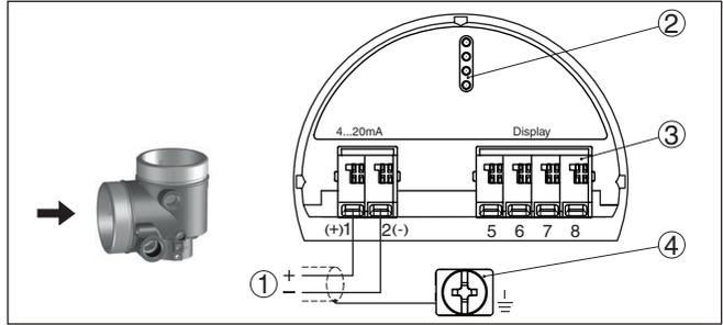
Abb. 12: Anschlussraum - Zweikammergehäuse
