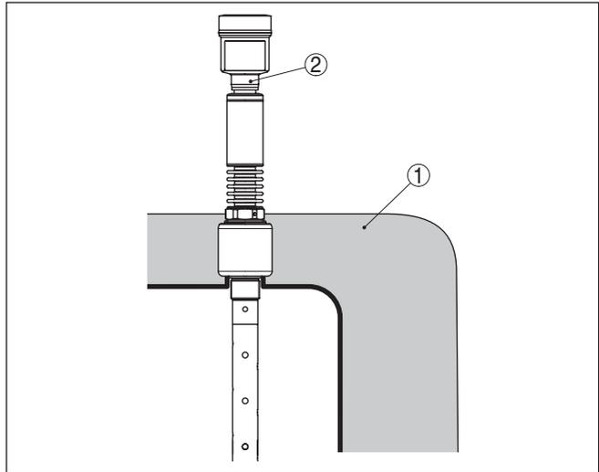
Abb. 7: Montage des Gerätes bei isolierten Behältern.
