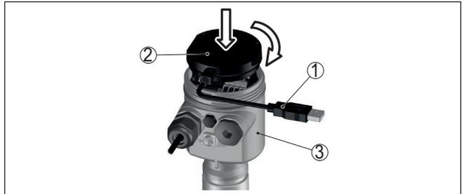
Abb. 18: Anschluss des PCs via Schnittstellenadapter direkt am Sensor
