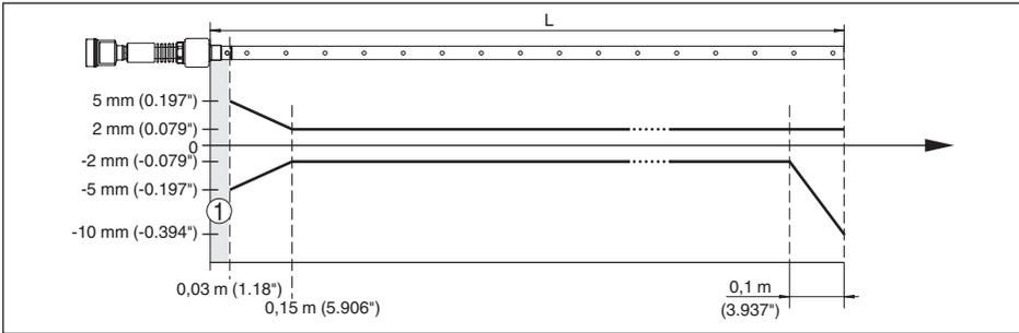
Abb. 25: Messabweichung VEGAFLEX 86 in Koaxialausführung in Medium Wasser (Messlänge bis 1,5 m/4.92 ft)
