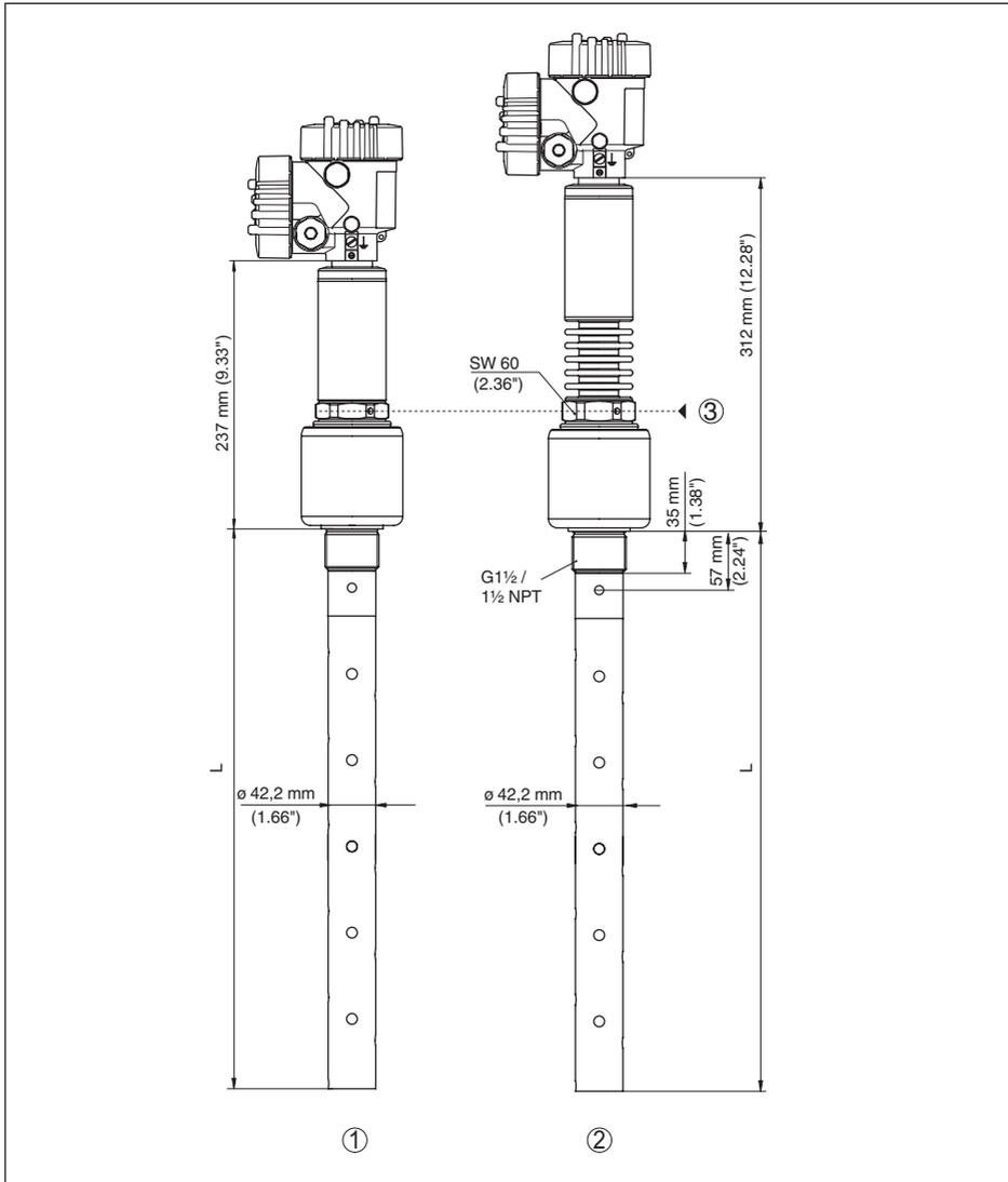
Abb. 34: VEGAFLEX 86, Gewindeausführung
