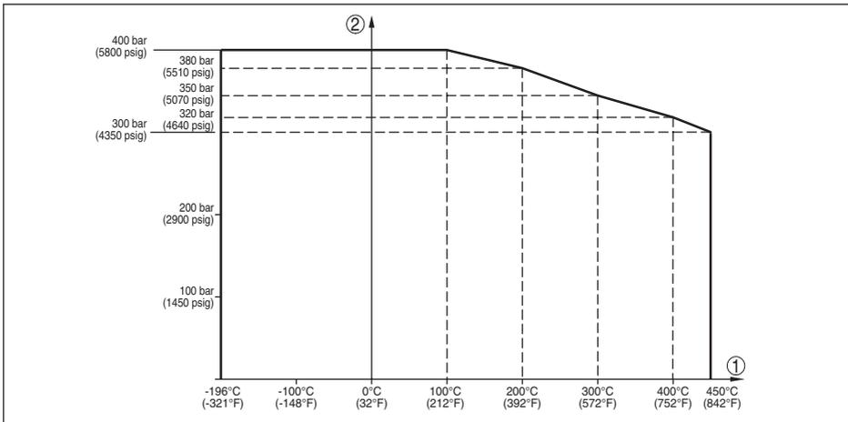
Abb. 32: Prozessdruck - Prozesstemperatur (Ausführung -196 ... +450 °C/-321 ... +842 °F)
