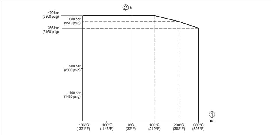
Abb. 31: Prozessdruck - Prozesstemperatur (Ausführung -196 ... +280 °C/-321 ... +536 °F)
