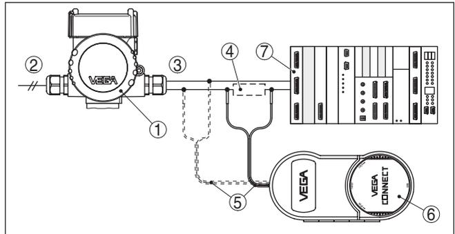
Abb. 19: Anschluss des PCs via HART an die Signalleitung
