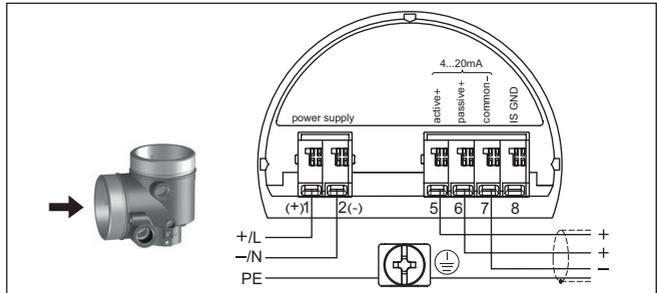
Abb. 11: Anschlussraum Zweikammergehäuse bei Netzspannung
