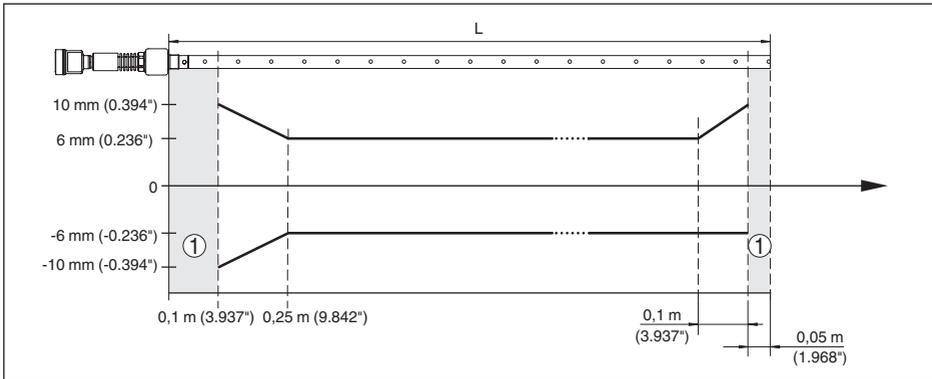
Abb. 28: Messabweichung VEGAFLEX 86 in Koaxialausführung in Medium Öl (Messlänge bis 6 m/19,69 ft)
