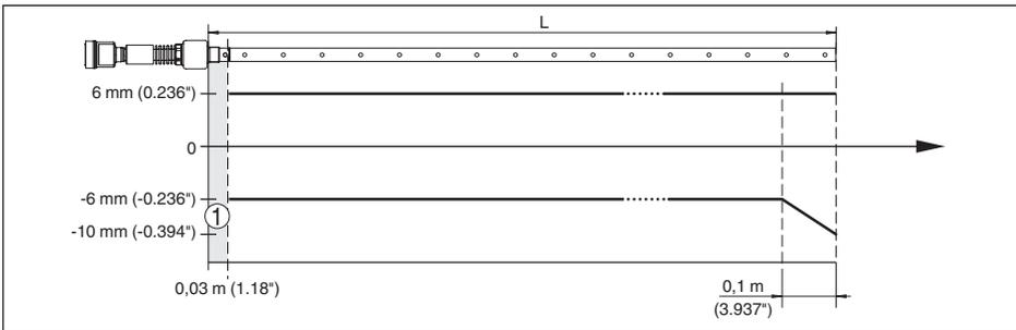
Abb. 26: Messabweichung VEGAFLEX 86 in Koaxialausführung in Medium Wasser (Messlänge bis 6 m/19.69 ft)
