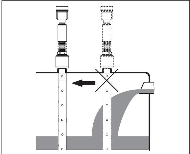
Abb. 5: Montage des Sensors bei einströmendem Medium
