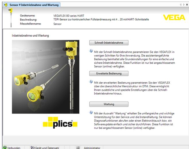
Abb. 21: Schnellinbetriebnahme auswählen
