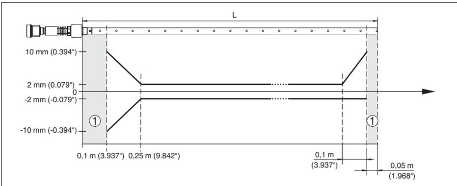
Abb. 27: Messabweichung VEGAFLEX 86 in Koaxialausführung in Medium Öl (Messlänge bis 1,5 m/4.92 ft)
