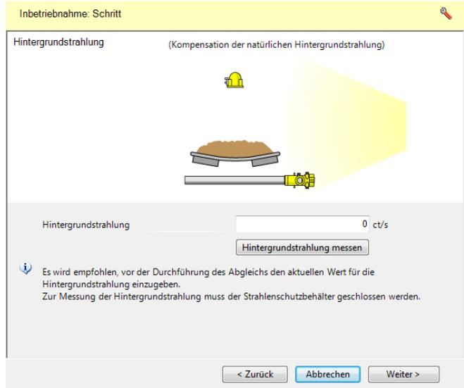
Abb. 30: Hintergrundstrahlung ausblenden
