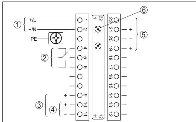
Fig. 9: Compartiment électronique et de raccordement des appareils non Ex et appareils avec sortie courant non à sécurité intrinsèque
