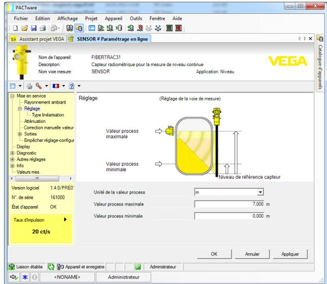
Fig. 24: Exemple de masque DTM
