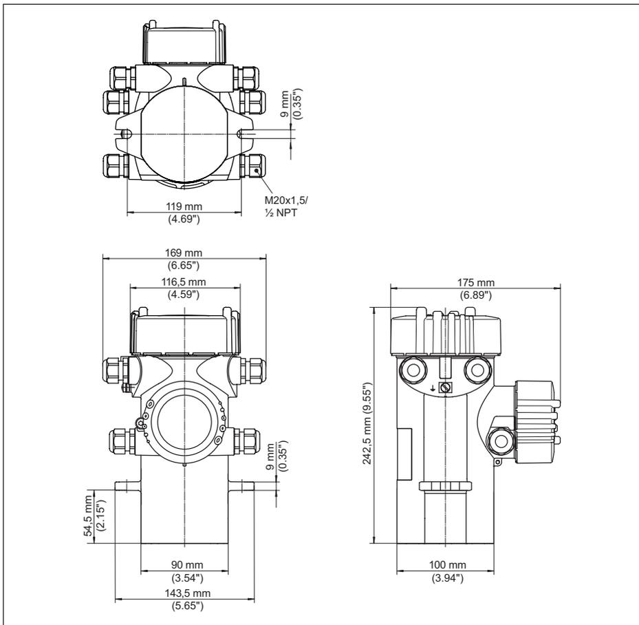
Fig. 28: Boîtier en aluminium ou boîtier en acier inox (moulage cire-perdue)
