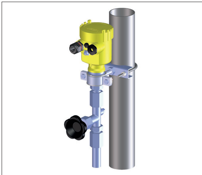
Fig. 15: Exemple de montage support d'instrument de mesure
