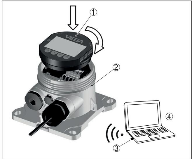
Abb. 25: Anschluss des PCs via Bluetooth-USB-Adapter
