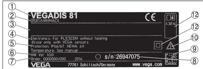
Abb. 1: Aufbau des Typschildes (Beispiel)
