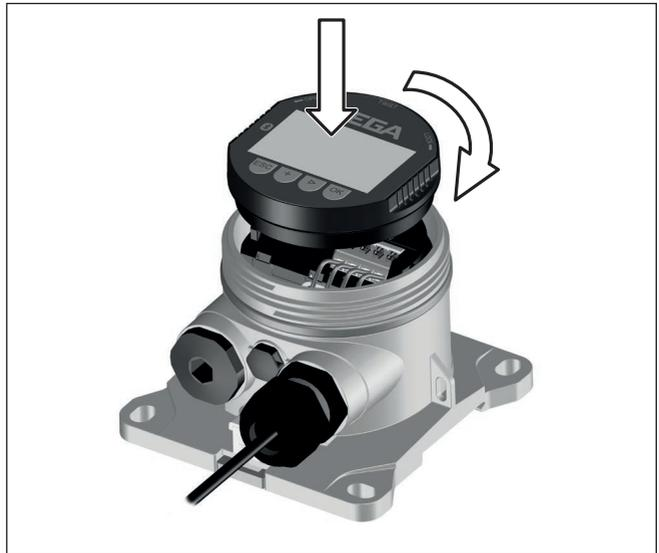
插图. 21: 显示和调整模块的安装
