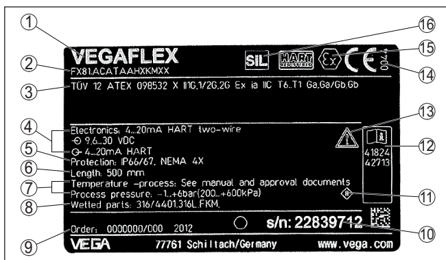
Abb. 1: Aufbau des Typschildes (Beispiel)
