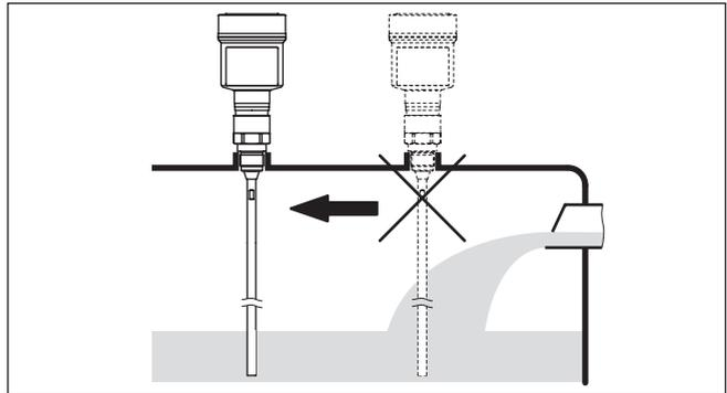
Abb. 8: Montage des Sensors bei einströmendem Medium
