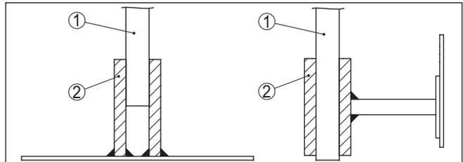
Abb. 11: Messsonde fixieren
