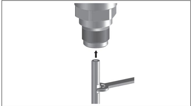
Abb. 29: Messseil bzw. Messstab wechseln
