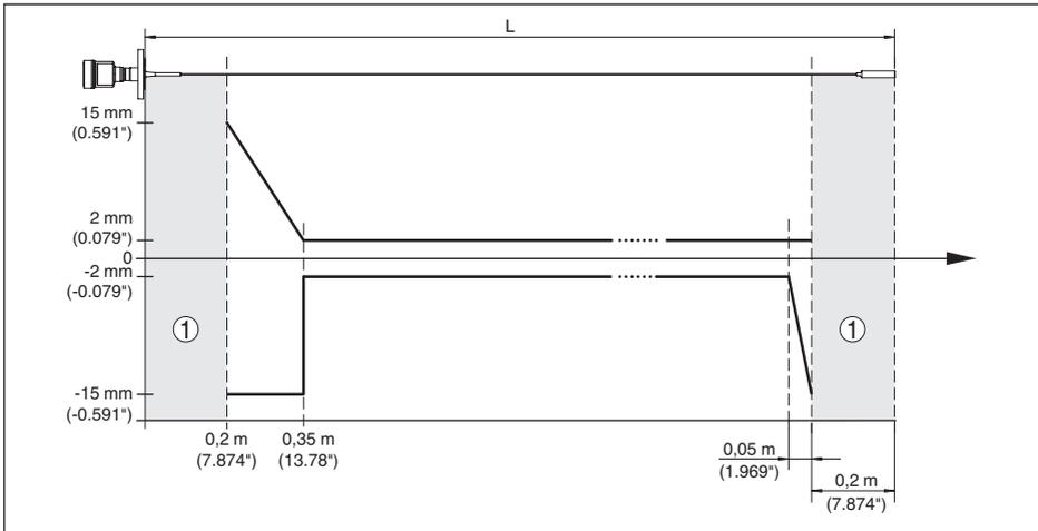
Abb. 38: Messabweichung VEGAFLEX 81 in Seilausführung (ø 4 mm/0.157 in, PFA-beschichtet) in Medium Öl
