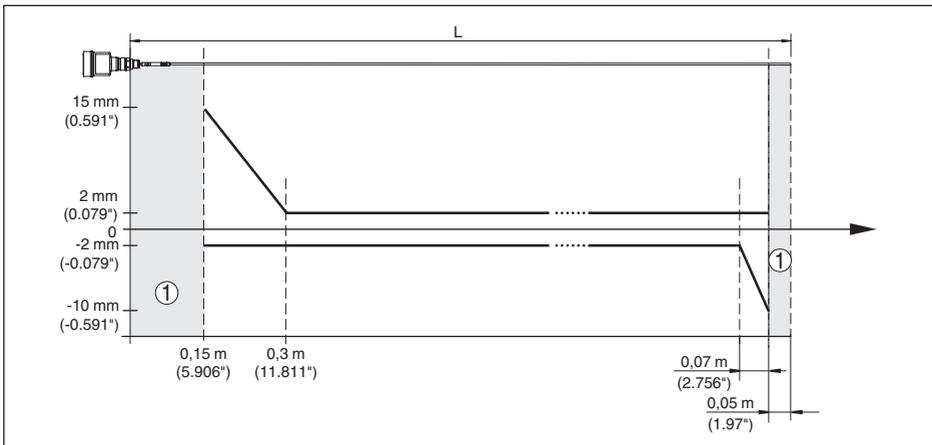
Abb. 33: Messabweichung VEGAFLEX 81 in Stabausführung in Medium Öl
