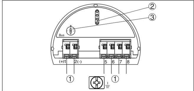
Abb. 15: Elektronikraum - Zweikammergehäuse
