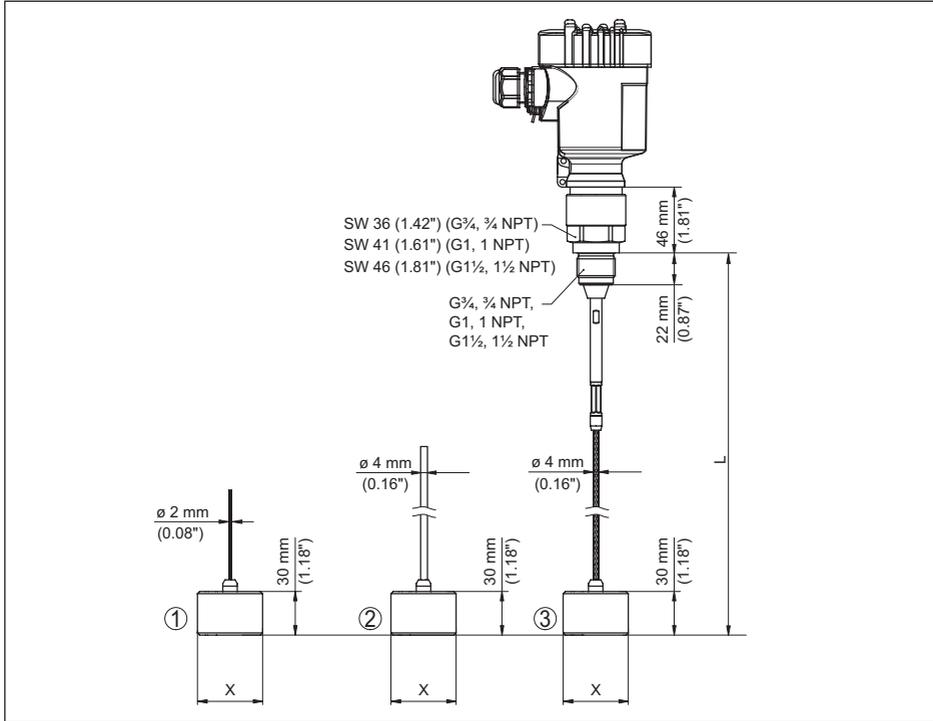
Abb. 47: VEGAFLEX 81, Gewindeausführung
