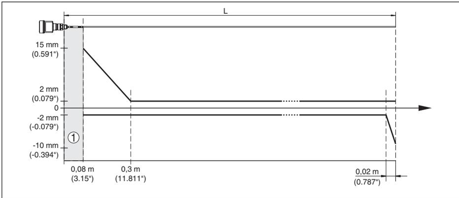
Abb. 32: Messabweichung VEGAFLEX 81 in Stabausführung in Medium Wasser
