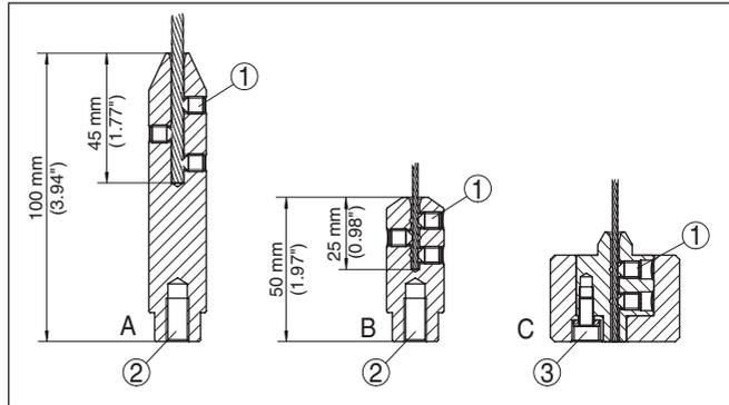
Abb. 30: Seilmesssonde kürzen
