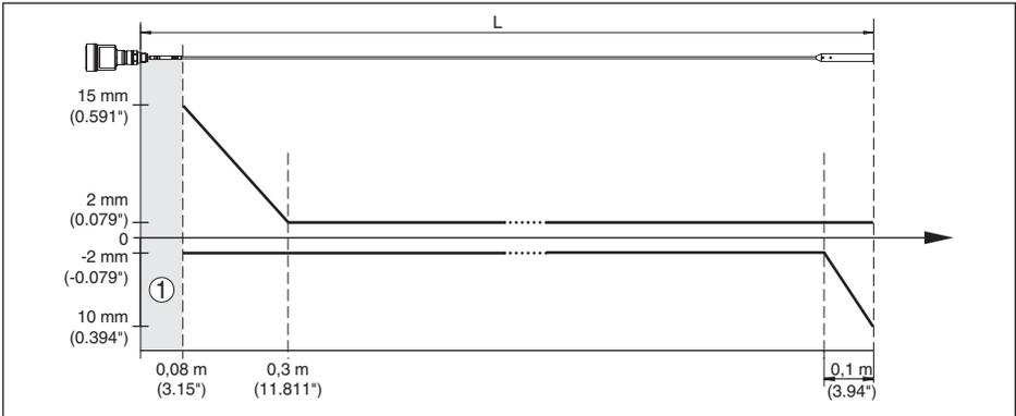
Abb. 34: Messabweichung VEGAFLEX 81 in Seilausführung in Medium Wasser
