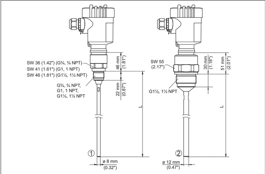
Abb. 48: VEGAFLEX 81, Gewindeausführung
