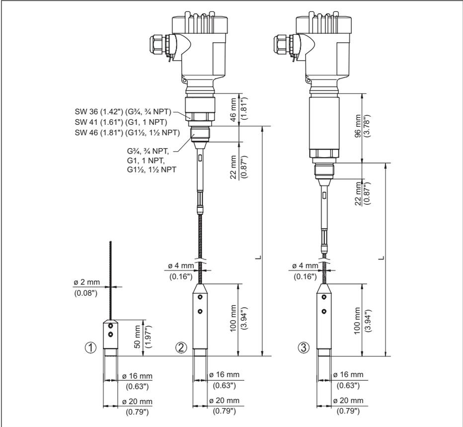
Abb. 46: VEGAFLEX 81, Gewindeausführung mit Straffgewicht (alle Straffgewichte mit Gewinde M8 für Ringschraube)
