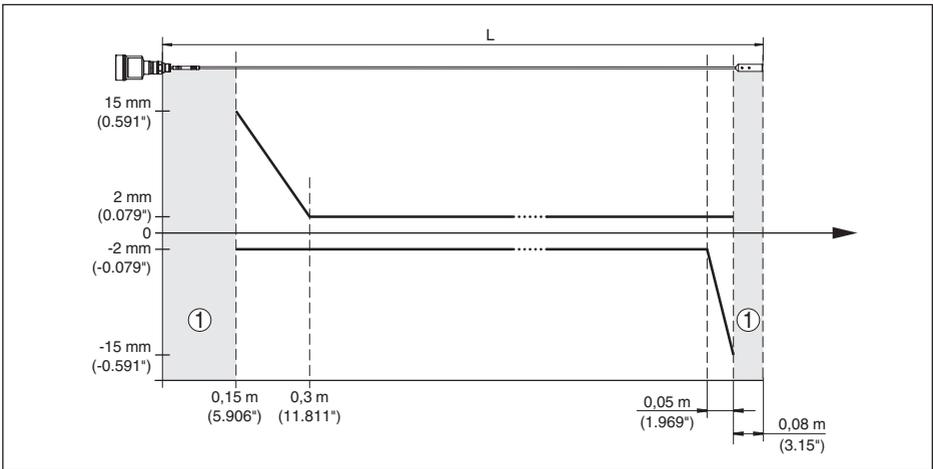
Abb. 35: Messabweichung VEGAFLEX 81 in Seilausführung ( $\varnothing$  2 mm/0.079 in), in Medium Öl
