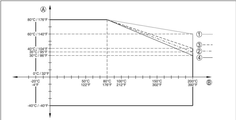
Abb. 40: Umgebungstemperatur - Prozesstemperatur, Ausführung mit Temperaturzwischenstück
